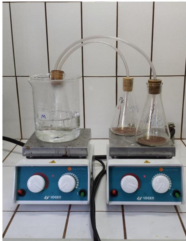
Figura 7 - Sistema adaptado de adsorção de piridina.
