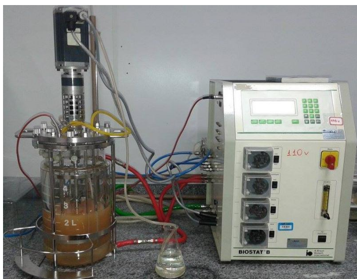
Figura 1. Fermentação alcoólica em fermentador de bancada.
