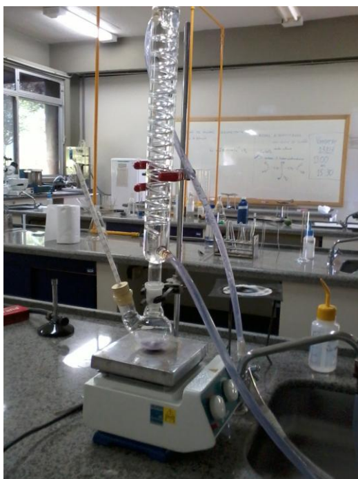
Figura 6: Sistema de refluxo com condensador para síntese das oxazolininas. Fonte: Própria.
