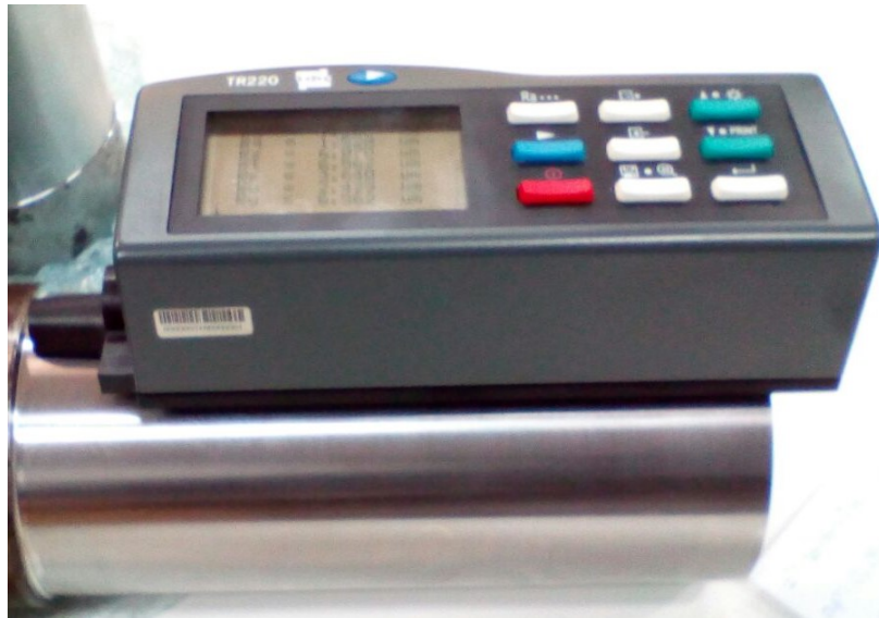
Figura 18 – Medição da rugosidade superficial média do corpo de prova
