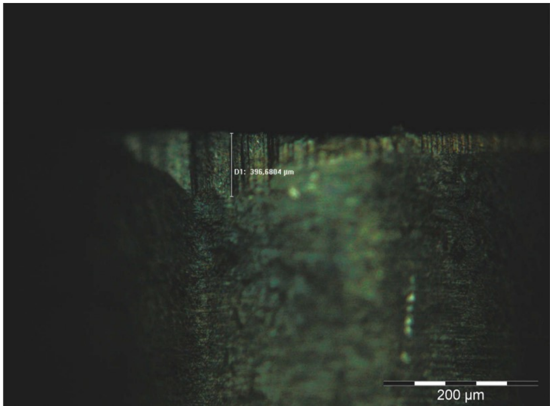
Figura 22 – Microscopia do raio da ponta do inserto fragmentado
