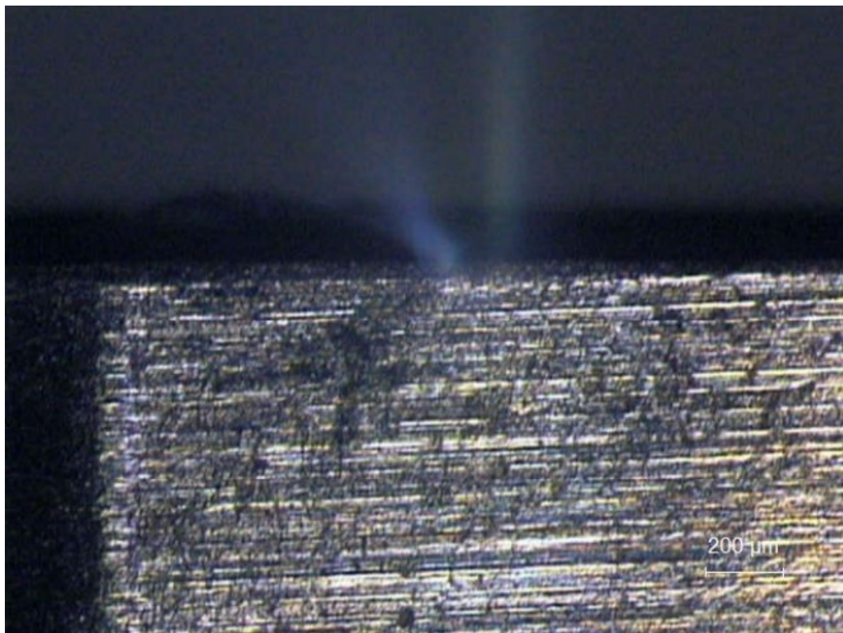
Figura 34 – Face primária de corte do inserto da quinta série de ensaios
