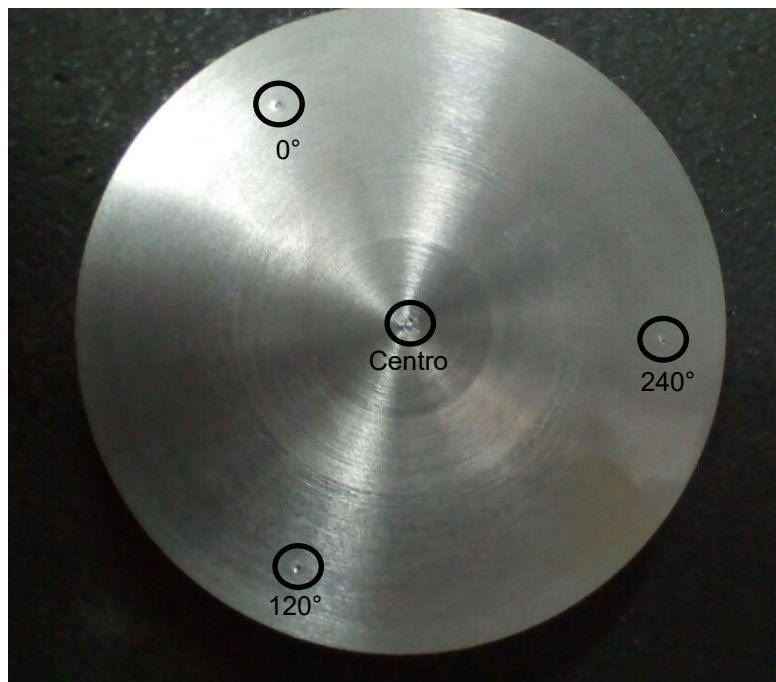
Figura 17 – Identificação das indentações na face do disco de prova
