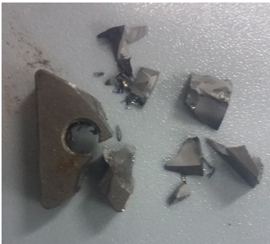
Figura 21 – Inserto cerâmico apresentando falha catastrófica
