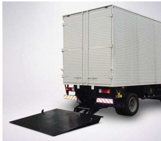
Figura 13 – Plataforma de elevação de carga
