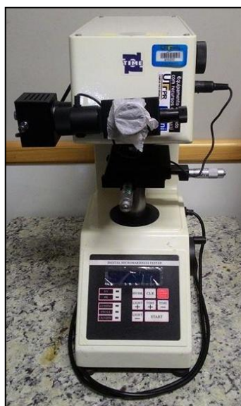
Figura 14 - Microdurômetro modelo TH710.
