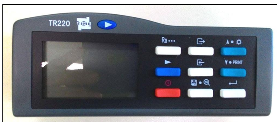
Figura 11 - Medidor de rugosidade de superfície TR220.
