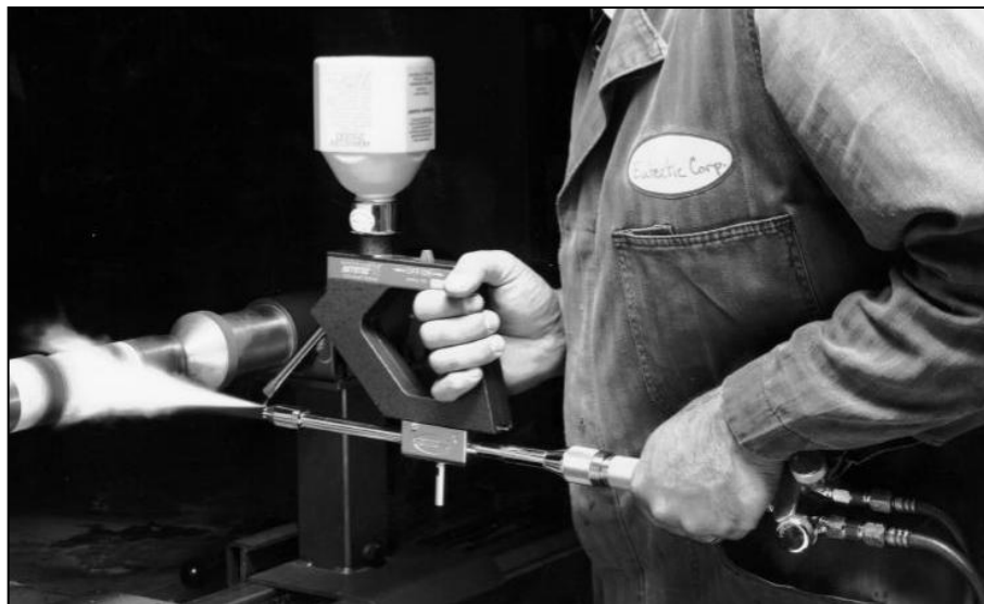
Figura 13 - Processo de aspersão térmica com a pistola da RotoTec 1A.
