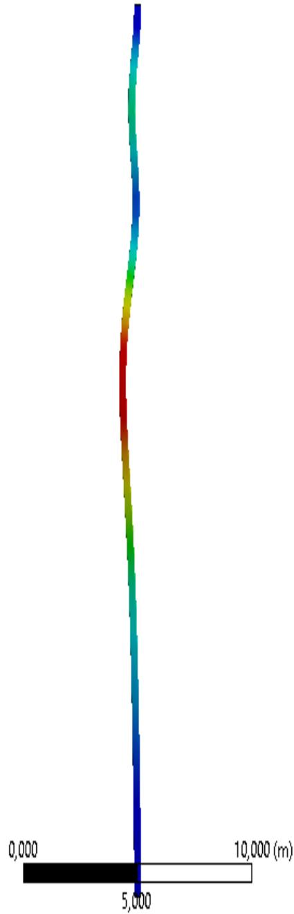
Figura 56 - 1º modo de flambagem para viga quadrada de 15 metros.
