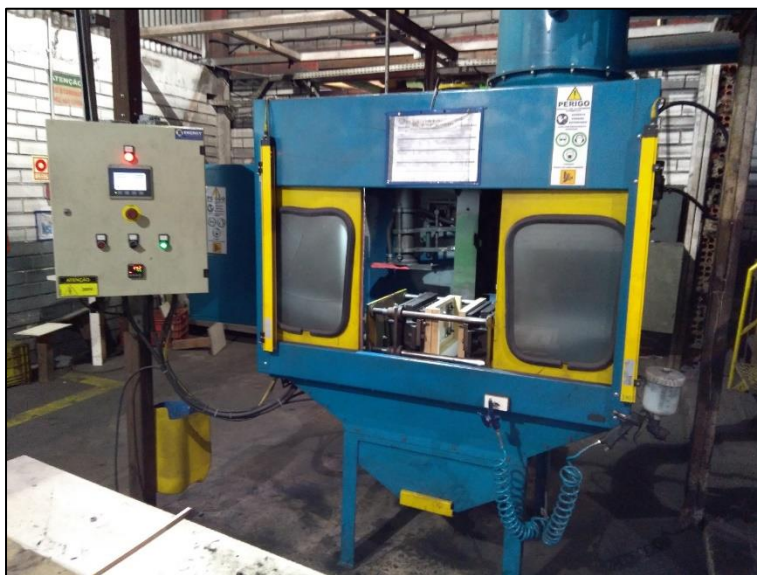
Figura 7 - Sopradora de machos e moldes de areia.
