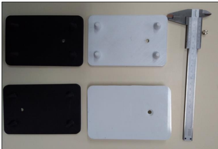
Figura 8 - Modelos confeccionados por manufatura aditiva.
