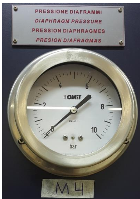
Figura 30 - Manômetro de Bourdon (M4), usado para a medir a pressão acima dos diafragmas.
