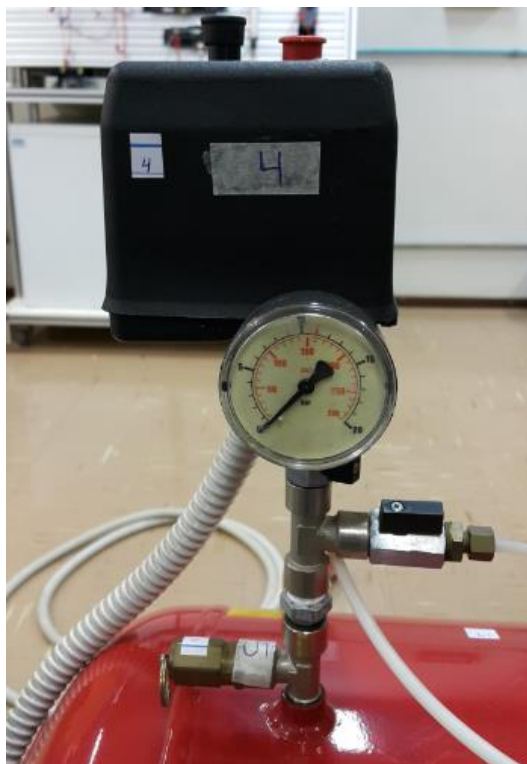
Figura 23 - Interruptor de ajuste da pressão máxima (4), juntamente com a válvula de segurança do reservatório/tanque (5).
