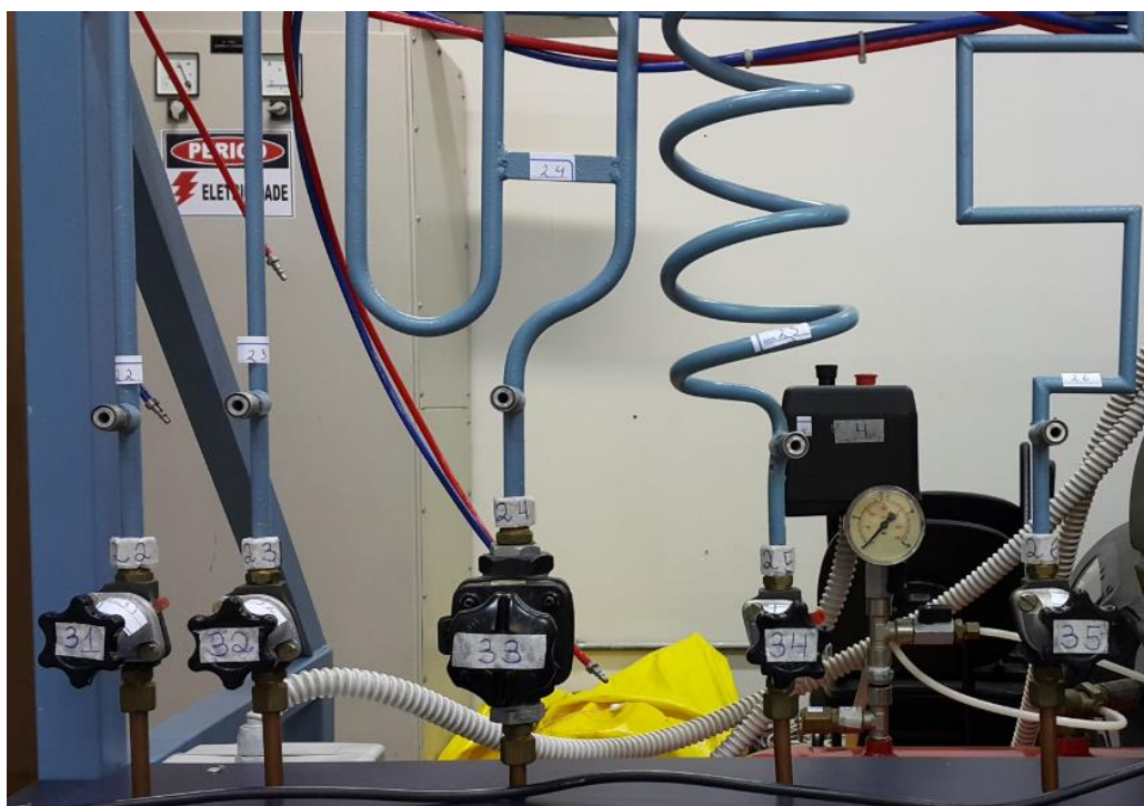
Figura 34 - Tubos perfilados com diferentes tamanhos e formatos (22-23-24-25-26), juntamente com suas válvulas reguladoras de vazão (31-32-33-34-35) respectivamente.
