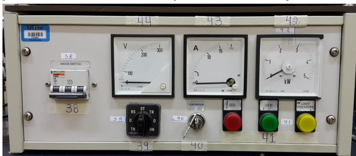
Figura 35 - Painel elétrico de controle e monitorização da bancada de testes do compressor PN30D.
