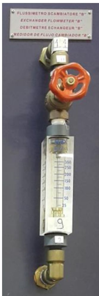
Figura 17 - Fluxômetro de água da 1ª fase, indicado pela etiqueta com número 9 e da válvula de ajuste e interrupção do fluxo de água (11).
