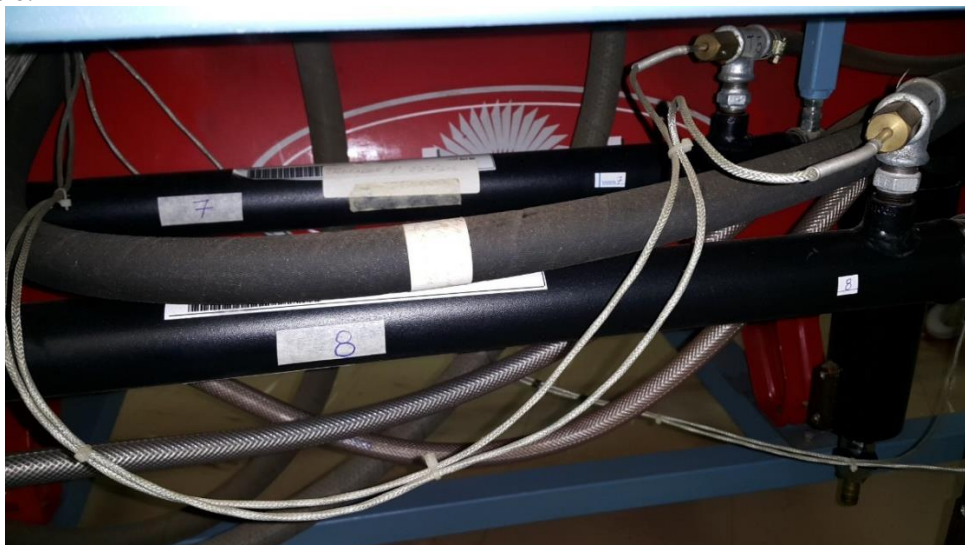
Figura 13 - Resfriador intermediário indicado pela etiqueta com número 7 e o esfriador final com etiqueta de número 8.
