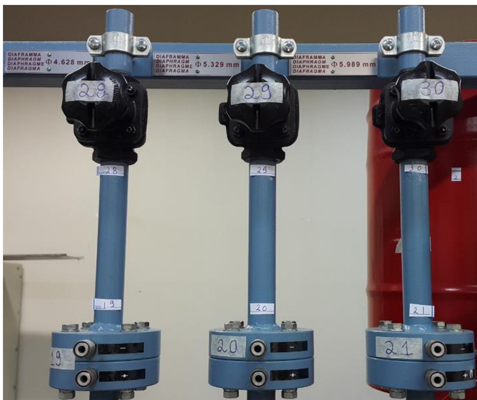
Figura 28 - Diafragmas com diâmetros de 4.628 mm (19), 5.329 mm (20), e 5.989 mm (21), juntamente com suas válvulas reguladoras de vazão (28-29-30) respectivamente.
