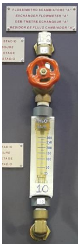
Figura 20 - Fluxômetro de água da 2ª fase, indicado pela etiqueta com número 10 e da válvula de ajuste e interrupção do fluxo de água (12).
