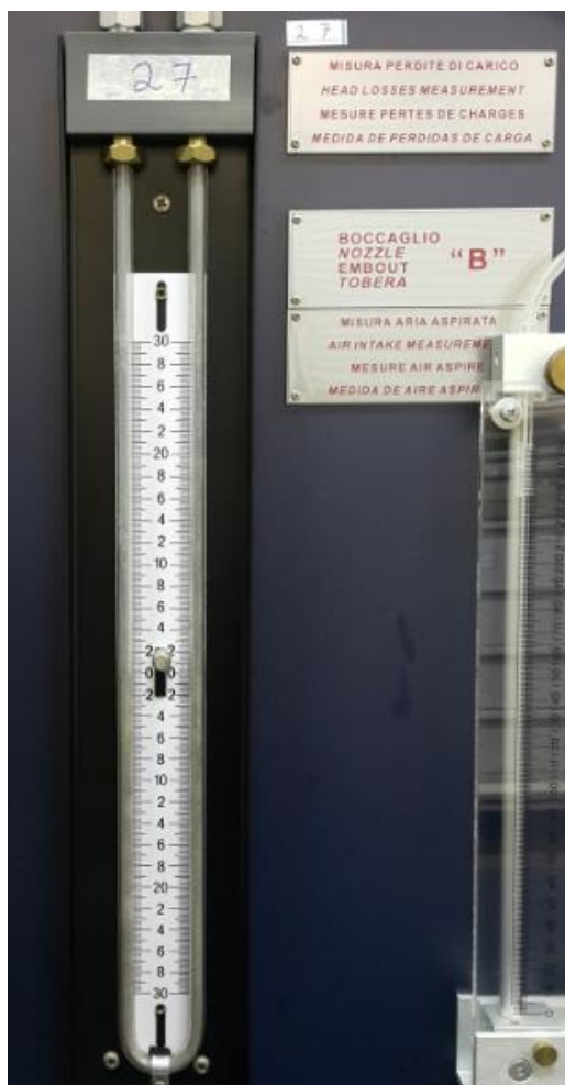
Figura 31 - Manômetro diferencial em “U” de mercúrio (27).
