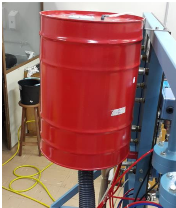
Figura 25 - Bocal calibrado montado na câmara de equilíbrio (2).
