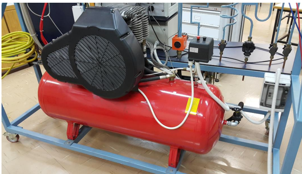
Figura 21 - Vista do reservatório/tanque de ar (14) do compressor PN30D.
