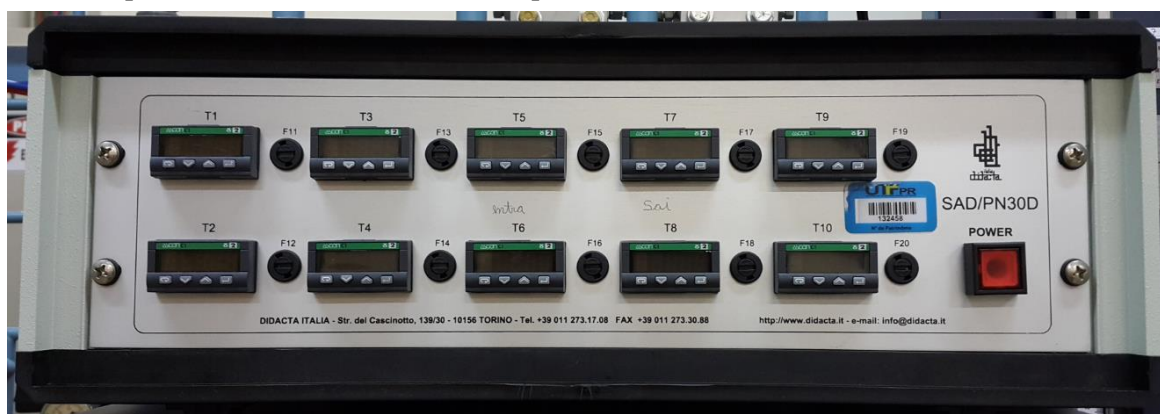
Figura 36 - Painel com os 10 monitores digitais de temperatura (45), possibilitando o acompanhamento de todas as temperaturas do sistema ao mesmo tempo.
