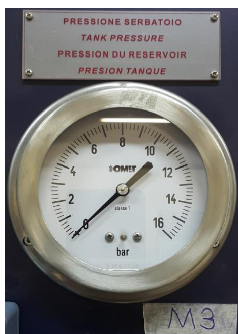
Figura 22 - Manômetro de Bourdon (M 3 ), usado para medir a pressão de distribuição no tanque reservatório de ar.
