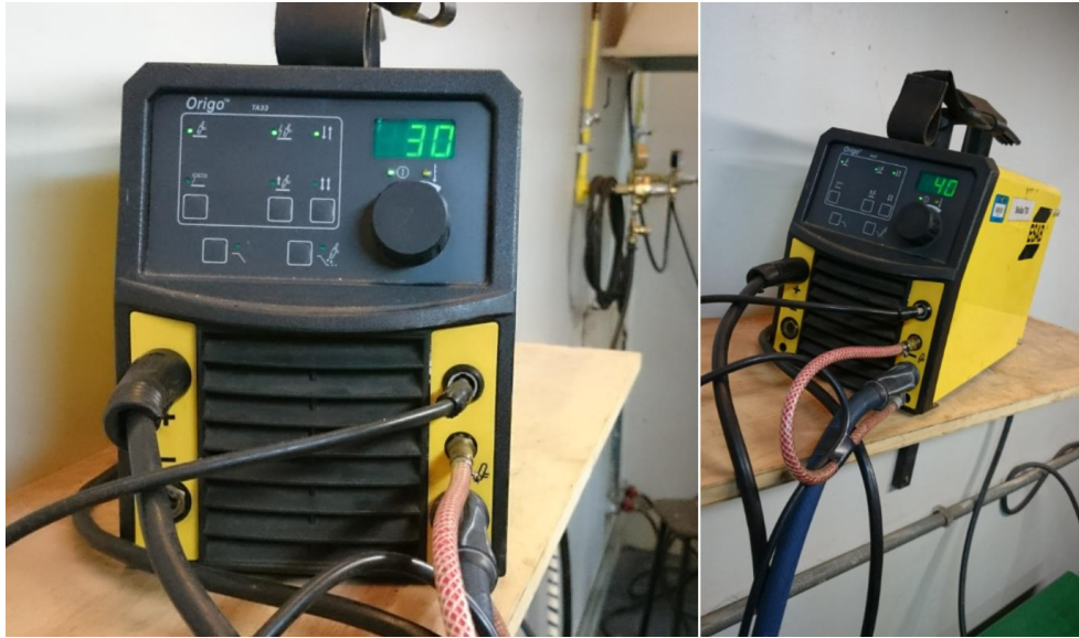
Figura 11 – Equipamento de soldagem TIG utilizado para refusão. Marca ESAB, modelo Origo TA33
