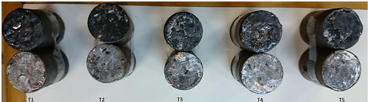
Figura 21 – Mecanismos de falha das amostras com refusão a 60 A. Falha predominante ocorreu na interface adesivo revestimento.
