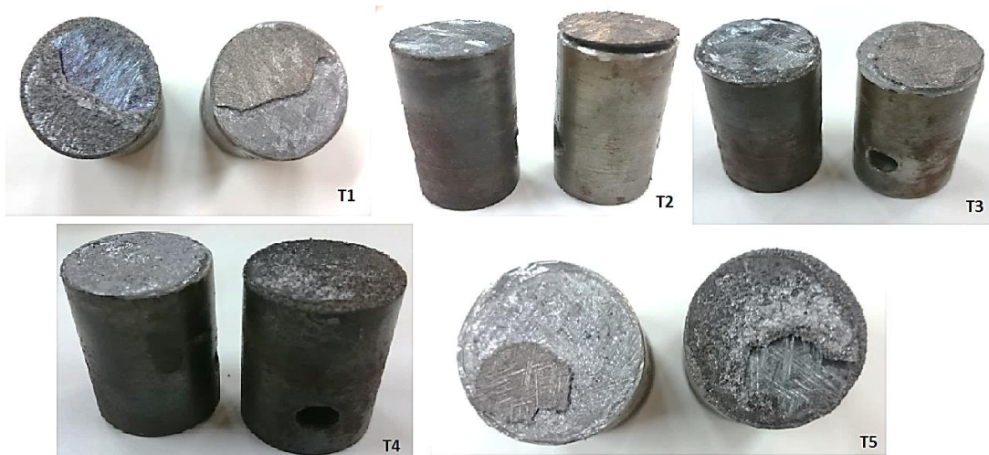
Figura 20 – Mecanismos de falha no ensaio de adesão. T1) e T5) falhas adesiva do revestimento e adesiva do adesivo. T2) e T3) falha adesiva do revestimento. T4) falha adesiva do adesivo.
