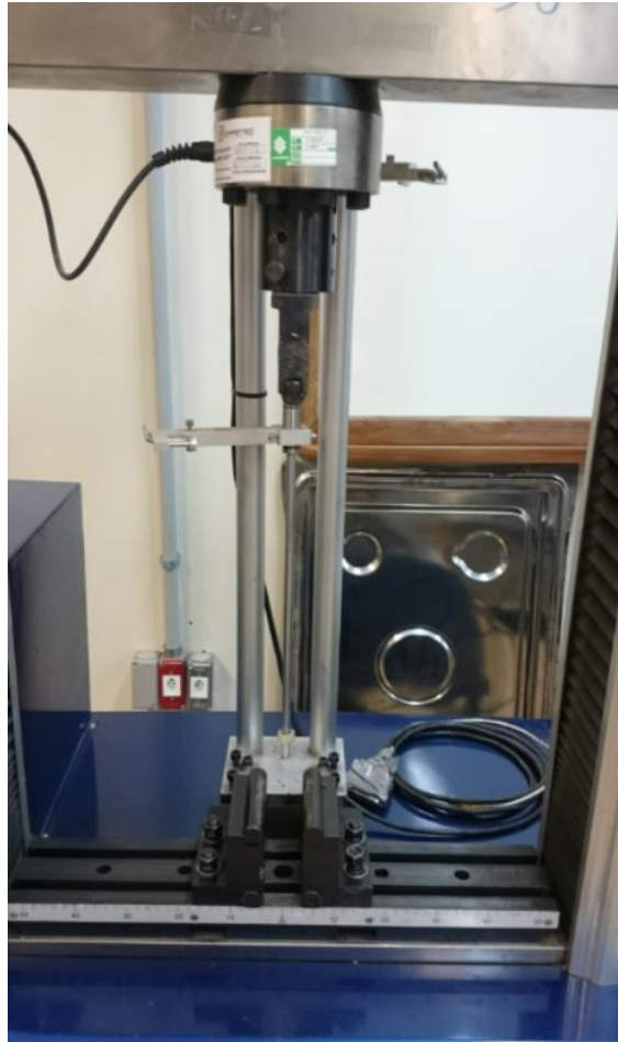
Figura 9 – Máquina de ensaios universal utilizada para realizar o ensaio de dobramento.
