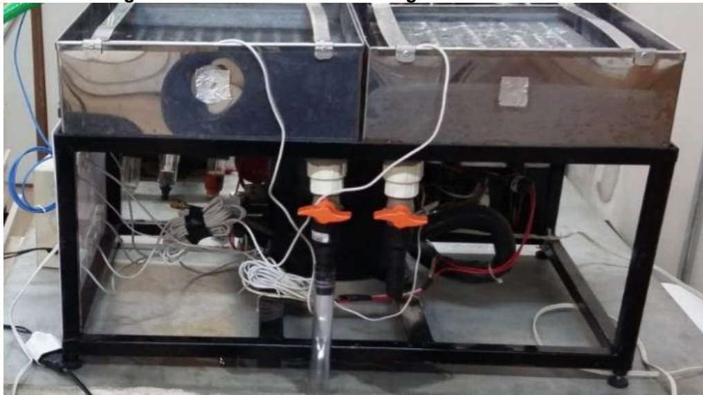
Figura 10 – Válvulas de saída da água dos reservatórios.
