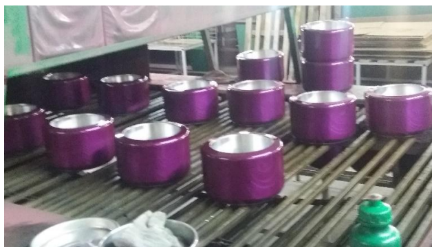
Imagem 11: retirar corpo da PP da estufa. Fonte a empresa em estudo.
