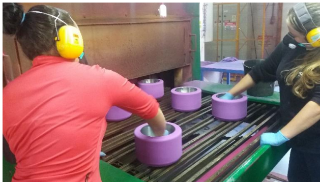
Imagem 10- limpeza do corpo da PP parte interna. Fonte a empresa em estudo.
