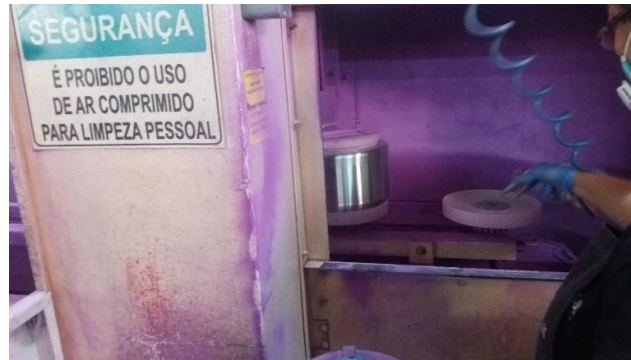
Imagem 8 - abastecer máquina de pintura com corpo da PP. Fonte a empresa em estudo.
