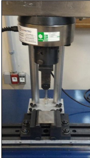
Figura 10 – Máquina de ensaio universal utilizado para o ensaio de dobramento
