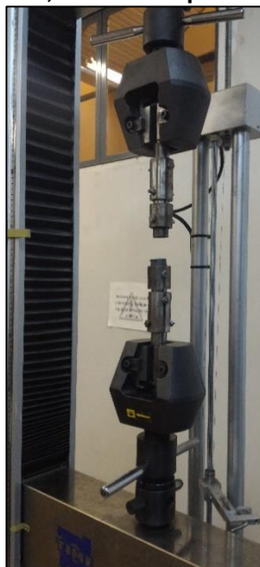
Figura 8 – Máquina de ensaio universal utilizado para o ensaio de adesão com o dispositivo construído para o ensaio, com os corpos de prova após a ruptura
