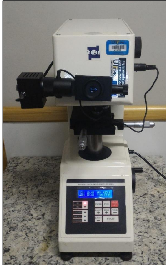
Figura 14 – Microdurômetro Time modelo TH – 710, utilizado para a medição da microdureza Vickers
