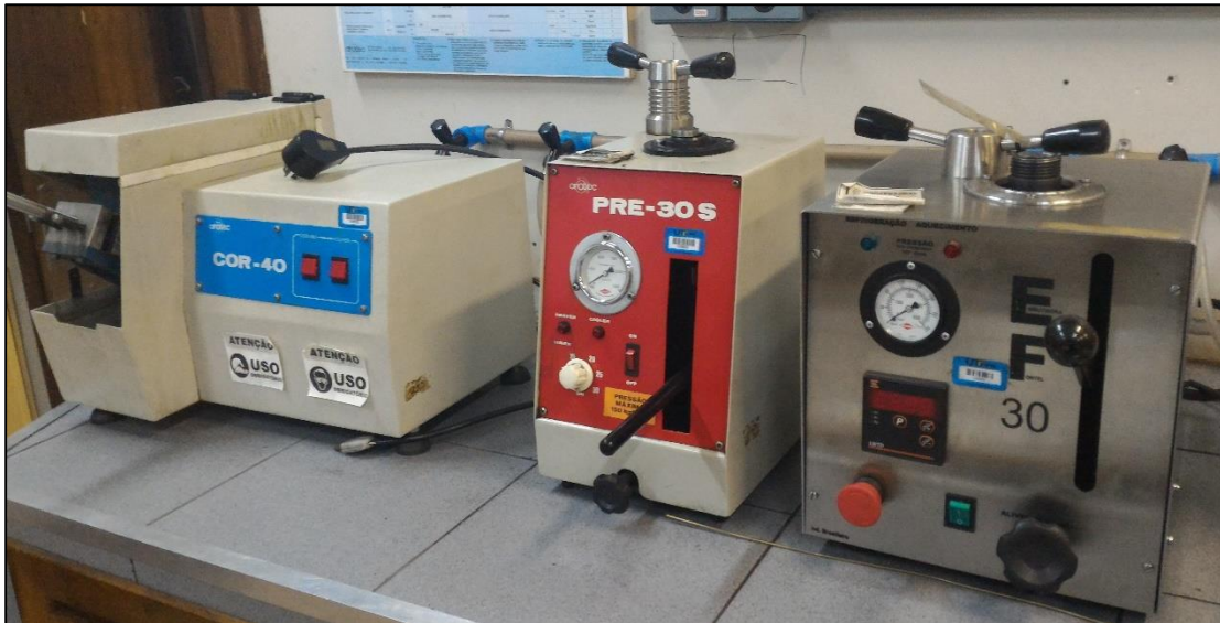
Figura 12 – Equipamentos para execução da microscopia ótica Cortadora metalográfica e prensas de embutimento
