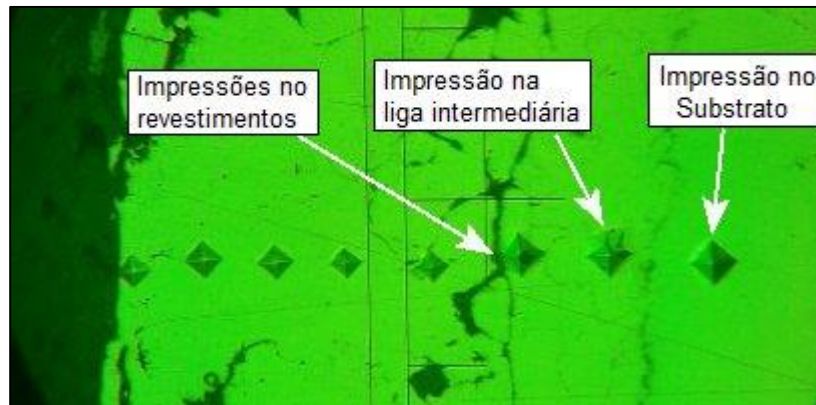
Figura 21 - Exemplo de impressões de microdureza do substrato até o revestimento aumentado 400x
