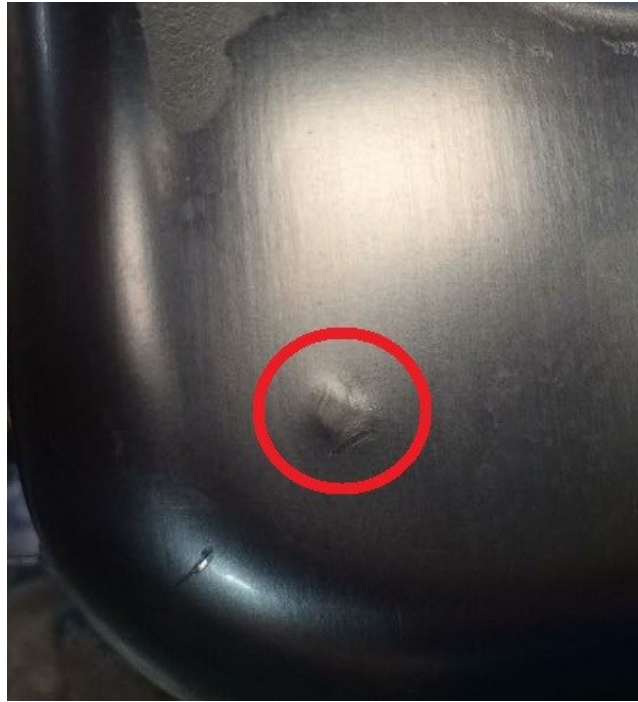
Figura 6- Marcações de peças estampadas devido ao retorno de retalho
