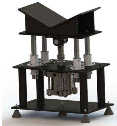
Figura 30 – Renderização do equipamento de teste de suspensão automotiva proposto
