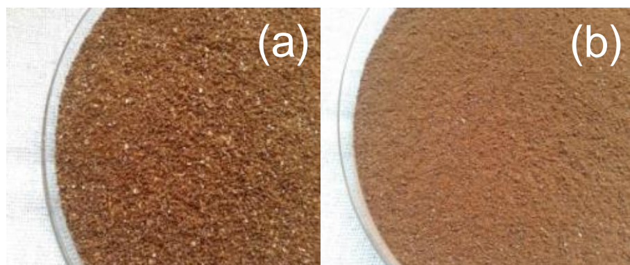
Figura 28 - (a) Moagem da amostra bruta, (b) Grânulos de 60 mesh.
