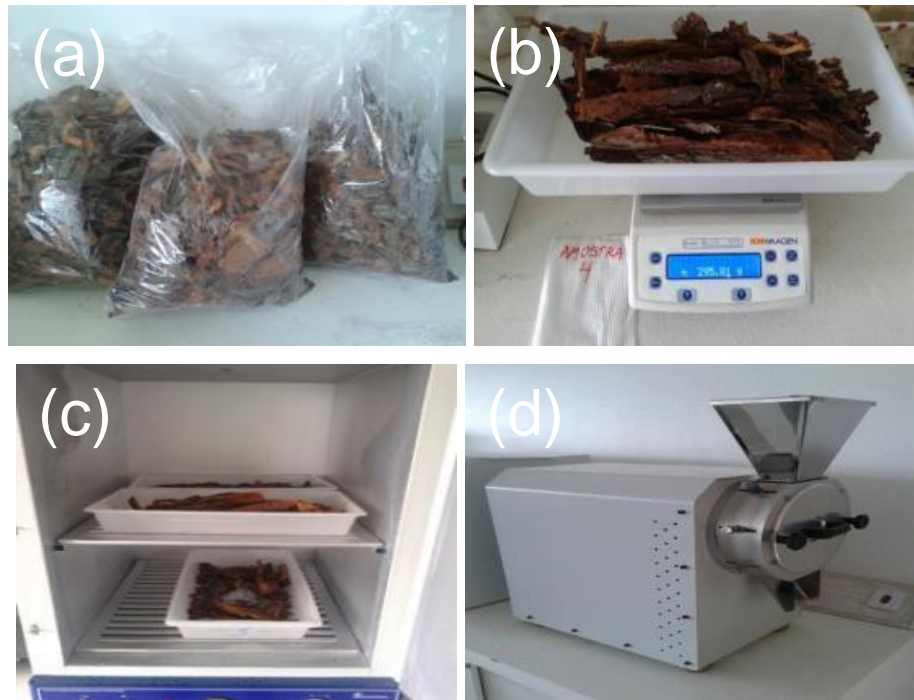
Figura 27 - Preparo das cascas no laboratório: (a) Armazenamento das amostras em sacos plásticos; (b) Pesagem da amostra com umidade; (c) Secagem das cascas; (d) Moagem da amostra.
