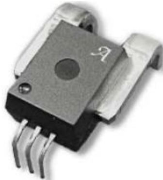
Figura 12 – Exemplo de sensor de efeito Hall ACS712 Fonte: (ALLEGRO, 2012).
