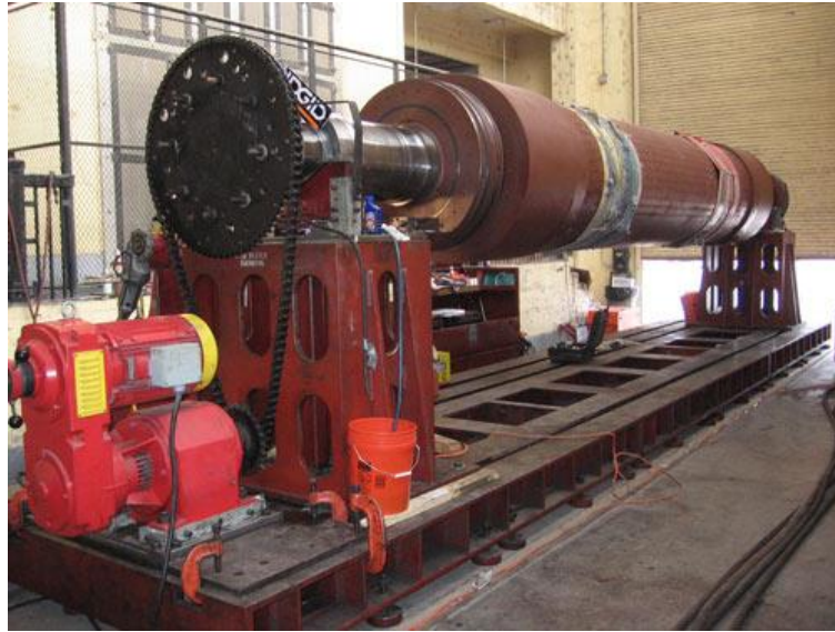
Figura 2 – Rotor do Gerador Síncrono de Polos Lisos. Fonte: Extraído de (POWER TECHNOLOGY, 2017)
