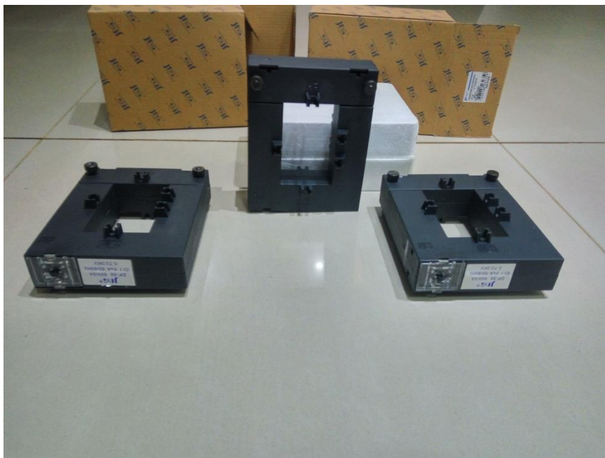
Figura 18 – Transformadores de Corrente (TCs) Utilizados Fonte: Autoria Própria.
