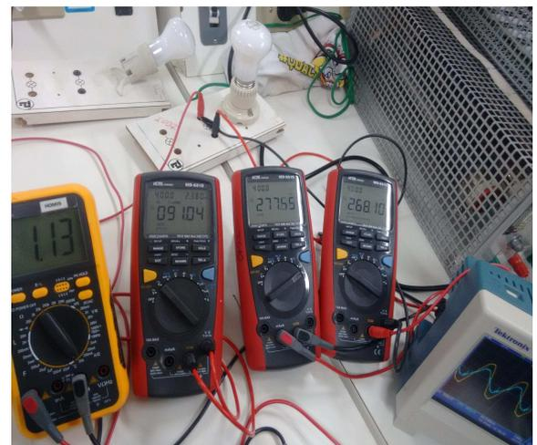
(d) Medidas Elétricas do Retificador Controlado para uma Tensão de Entrada de 91 V.
