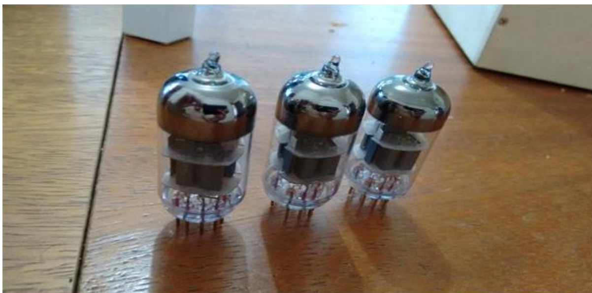
Figura 53 - Válvulas utilizadas no protótipo Fonte: Autoria Própria.
