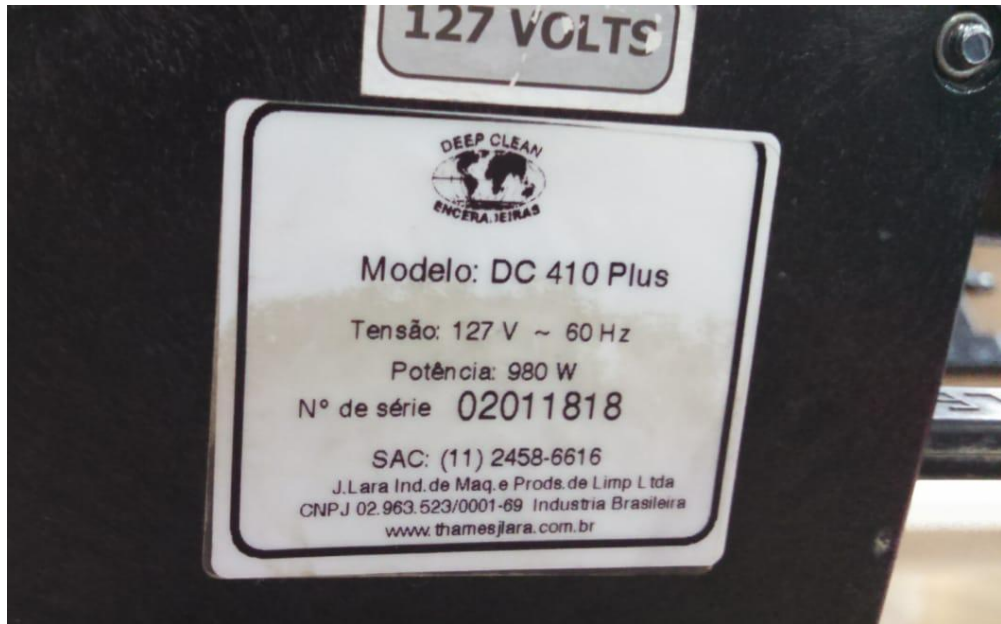
Figura 24 - Dados encontrados na placa da enceradora. Fonte: Autoria própria.
