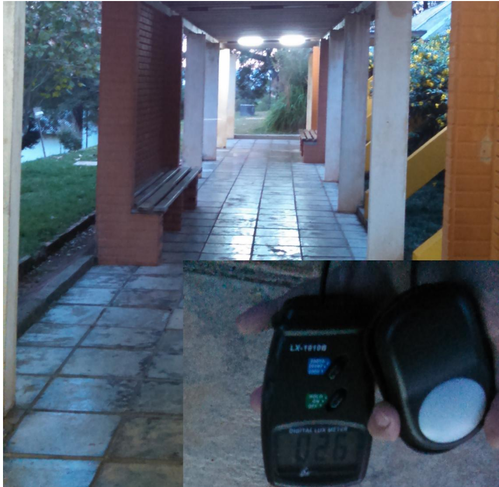
Figura 6 - Acesso ao bloco Q, com medição de luminosidade no ambiente da foto às 07:08, 11 de maio de 2018. Fonte: Autoria própria.
