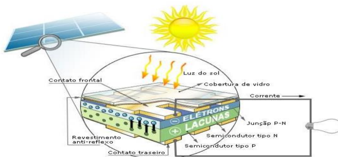
Figura 11 - Princípio de funcionamento de uma célula fotovoltaica. Fonte: (TAVARES, 2009).
