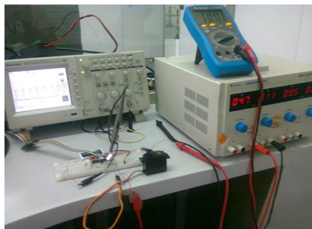
Figura 25 - Ajustes do acionamento do servomotor através de PWM.
