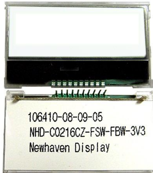
Figura15 - Display NHD-C0216CZ-FSW-FBW-3V3. Fonte: Newhaven Display (2013).
