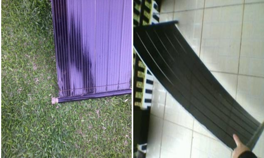
Figura 30–Pintura Painel PVC. a) Painel após pintura. b) Painel após deformação. Fonte: Autoria Própria
