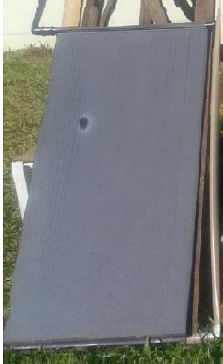
Figura 31 - Pannel Alveolar após pintura com tinta resistente a altas temperaturas. Fonte: Autoria própria.
