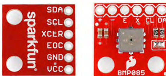
Figura 9 – Placa de circuito impresso com o sensor BMP085.
