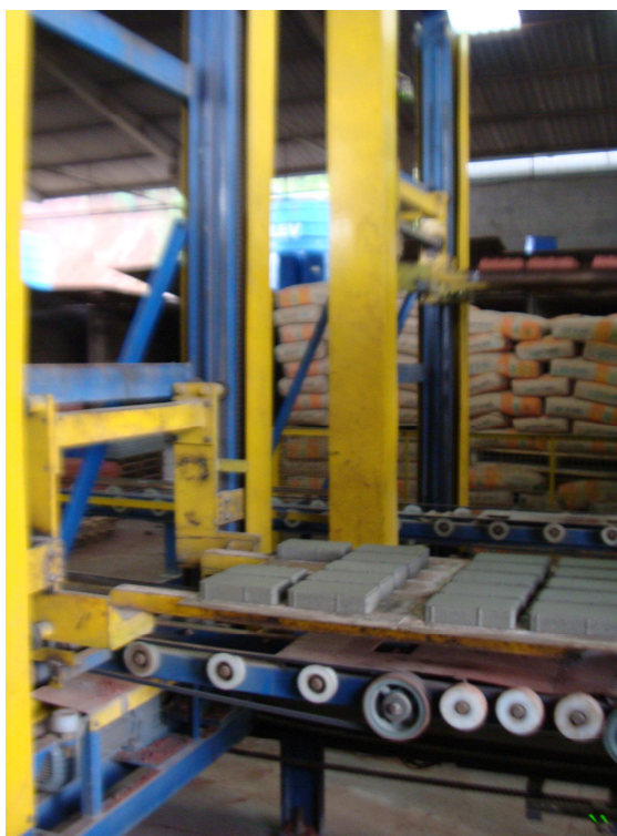
Figura 18: Elevadores de forma e desforma. Fonte: Autoria própria.
