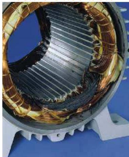
Figura 8 - Falha do Tipo: Curto Entre Espiras e Bobina Curto-Circuitada. Fonte: WEG (2010)
