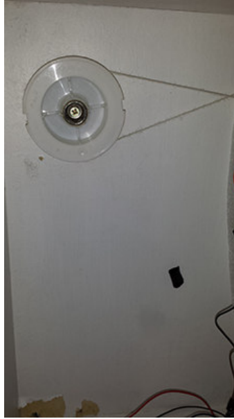
Figura 57 - Visão interna do protótipo com a engrenagem da cortina
