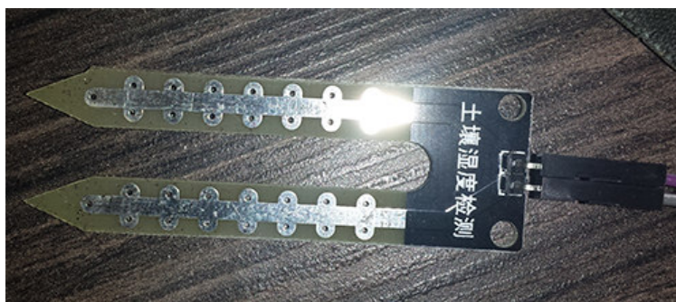
Figura 15 - Sonda para medição de umidade do solo
