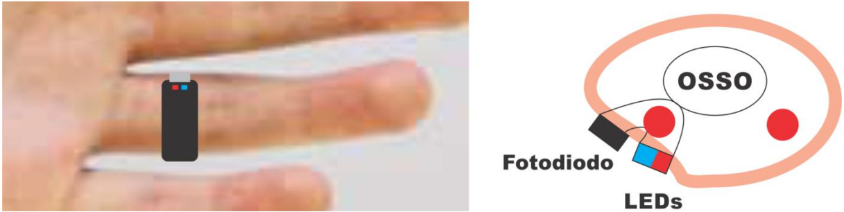
Figura 12 – Posição do anel-sensor e configuração dos componentes no anel. Fonte: Autoria própria.
