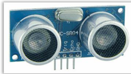
Figura 22 - Sensor HC-SR04 Fonte: Marlin (2016).
