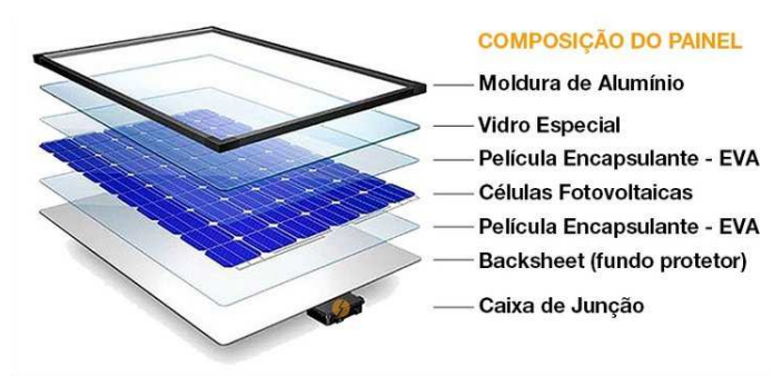
Figura 2: Constituição de um painel solar.
