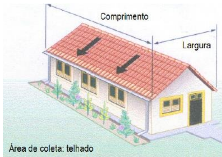
Figura 4: Área de coleta de água de chuva - telhado Fonte: May (2004)
