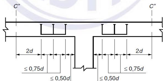
Figura 39: Disposição da armadura de punção em corte
