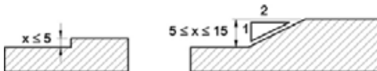
Figura 10 - Tratamento de desníveis – Exemplo NBR 9050/2004 – p. 39
