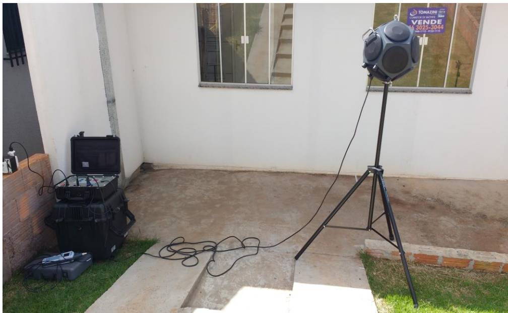
Figura 29 - Equipamentos utilizados para medição acústica Fonte: Autoria própria (2017).
