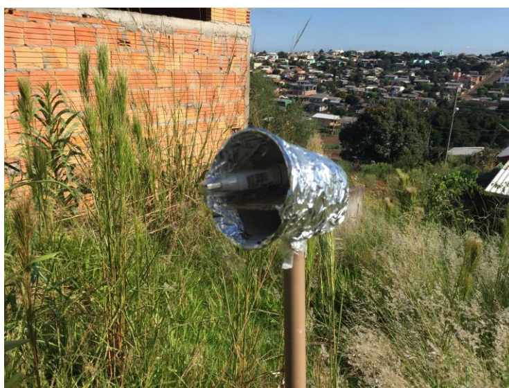
Figura 28 – Protótipo para medição de temperatura externa Fonte: Autoria própria (2017).
