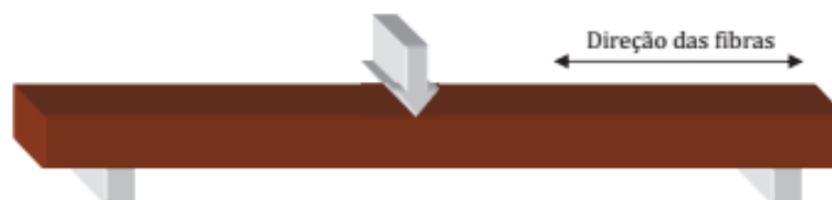
Figura 4 – Ensaio de resistência flexão Fonte: Melo (2013).
