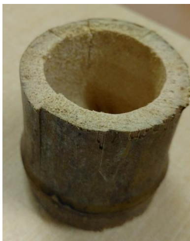
Figura 53: Detalhe do rompimento do CP Fonte: Própria
