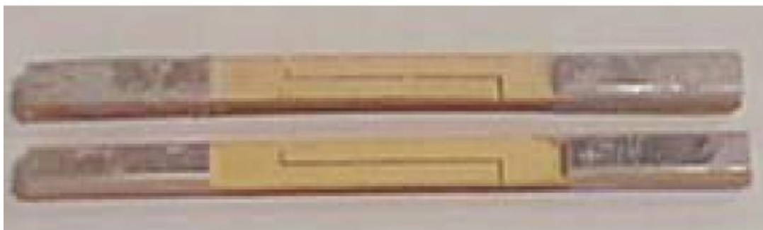
Figura 54: Corpos de prova para cisalhamento interlaminar Fonte: CRUZ, 2002
