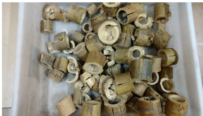
Figura 50: Corpos de prova rompidos à compressão Fonte: Própria
