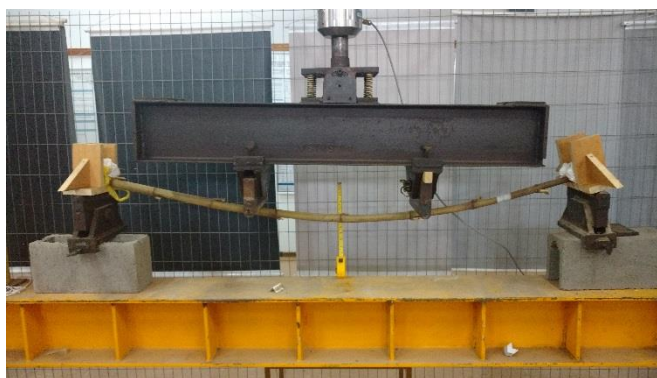
Figura 44: Metodologia utilizada para aferição da flecha Fonte: Própria
