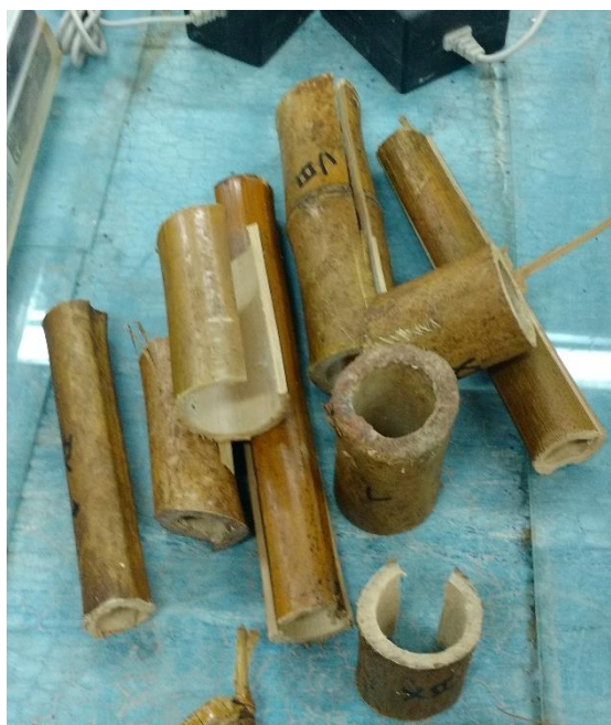
Figura 38: Corpos de prova utilizados na análise do teor de umidade após secagem. Fonte: Própria
