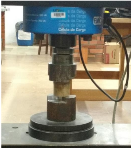
Figura 51: Ensaio de CP ao cisalhamento Fonte: Própria
