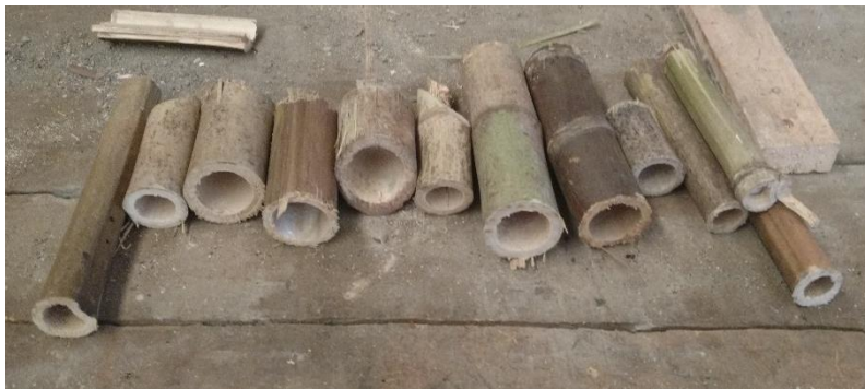
Figura 37: Corpos de prova utilizados na análise do teor de umidade, antes da secagem. Fonte: Própria
