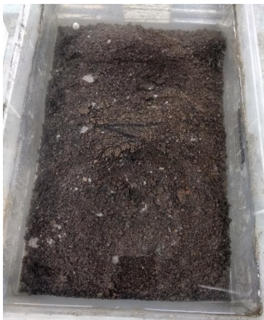
Figura 57 - Bloco minutos depois da imersão em água para ensaio de durabilidade Fonte: Acervo Pessoal (2017).
