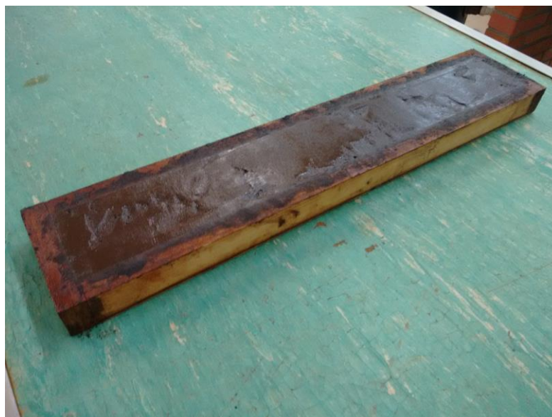
Figura 23 - Teste da caixa para ensaio de retração Fonte: Acervo Pessoal (2017).
