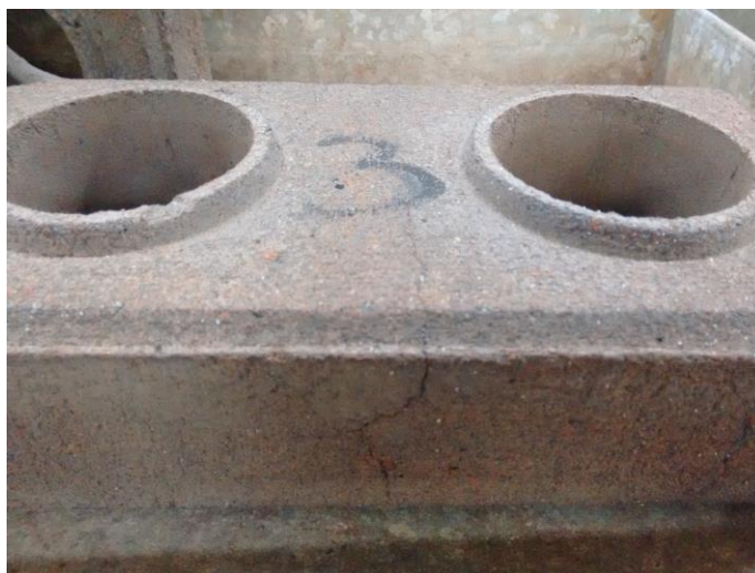
Figura 60 - Bloco B3 após ensaio de durabilidade
