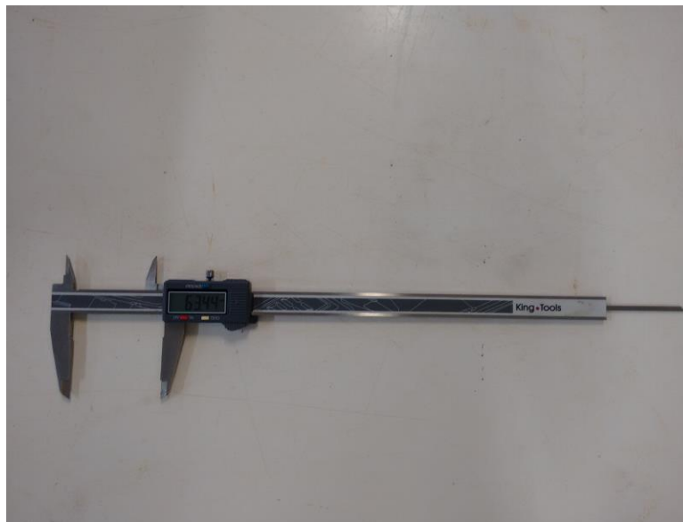
Figura 49 - Paquímetro digital utilizado nas medições Fonte: Acervo Pessoal (2017).
