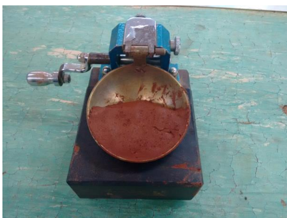
Figura 7 - Equipamento Casa Grande para ensaio de limite de liquidez Fonte: Acervo Pessoal (2017).
