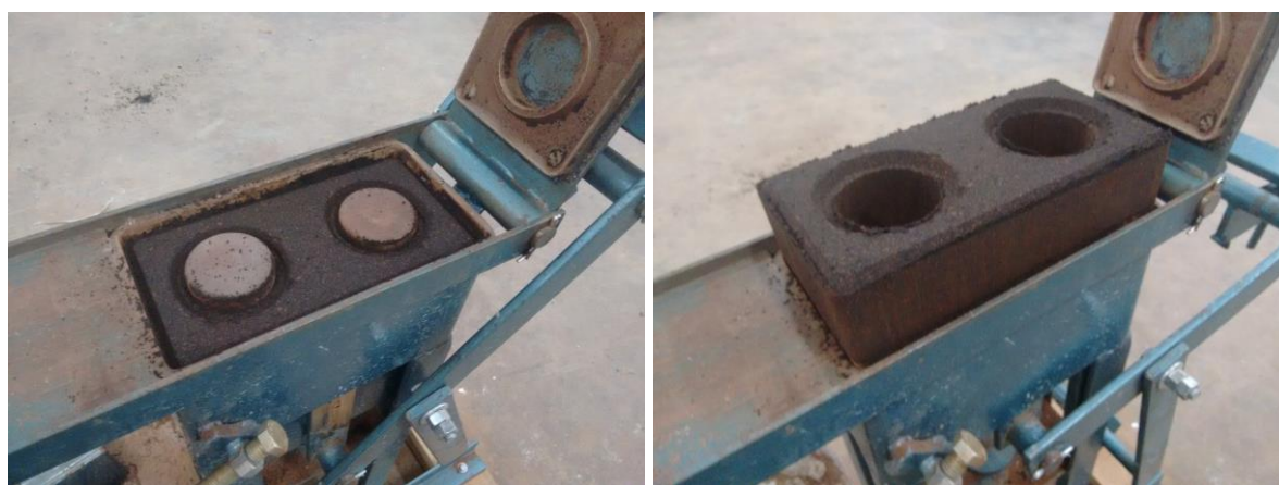
(a) (b) Figura 36 - Moldagem dos blocos: (a) Bloco dentro da prensa; (b) Bloco após compactação extraído da prensa
