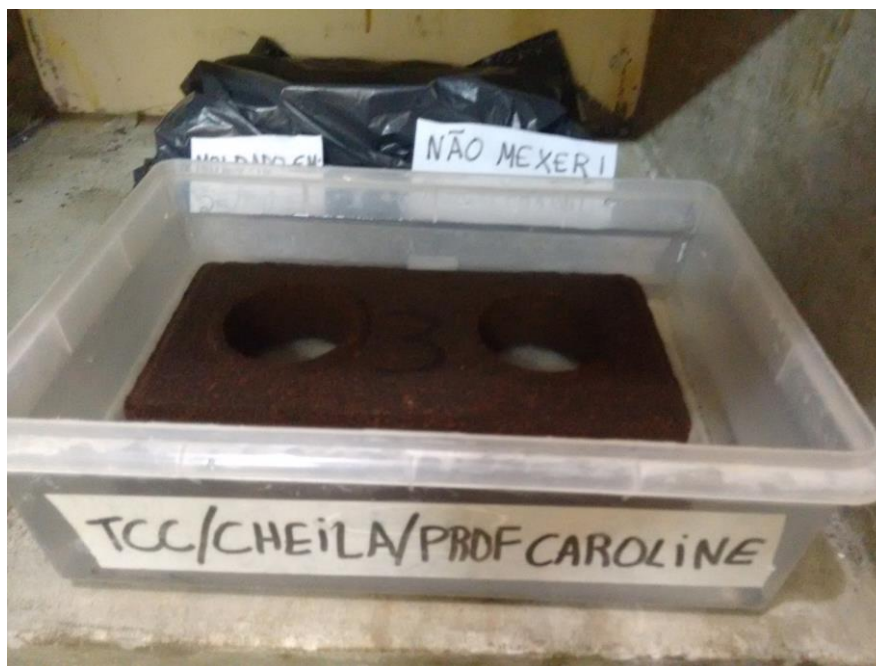
Figura 45 - Bloco submerso em água em ensaio de absorção
