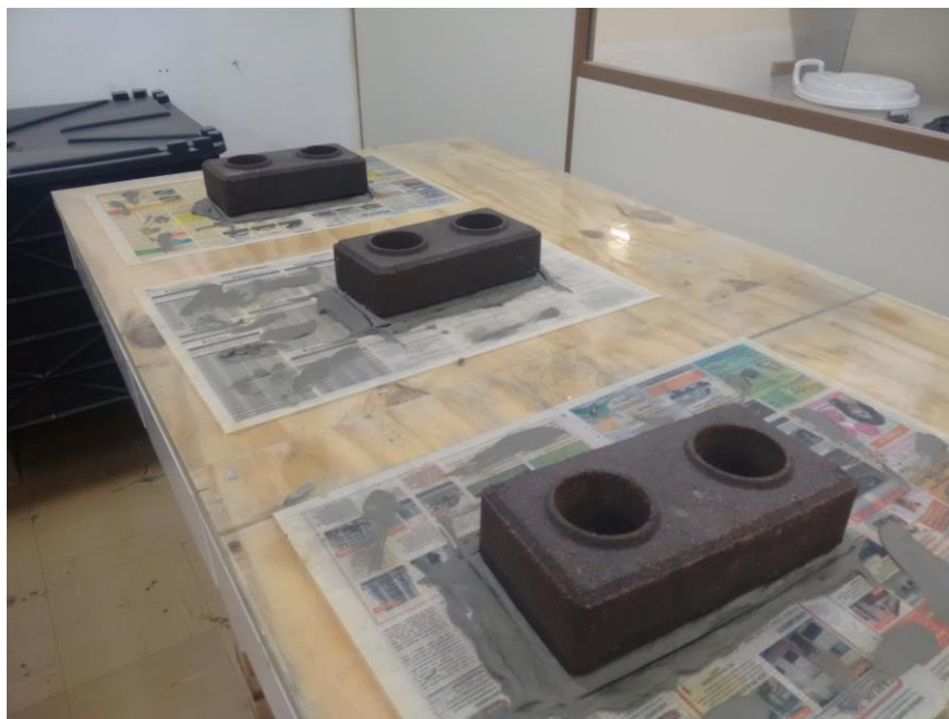
Figura 40 - Blocos capeados em apenas um dos lados Fonte: Acervo Pessoal (2017).
