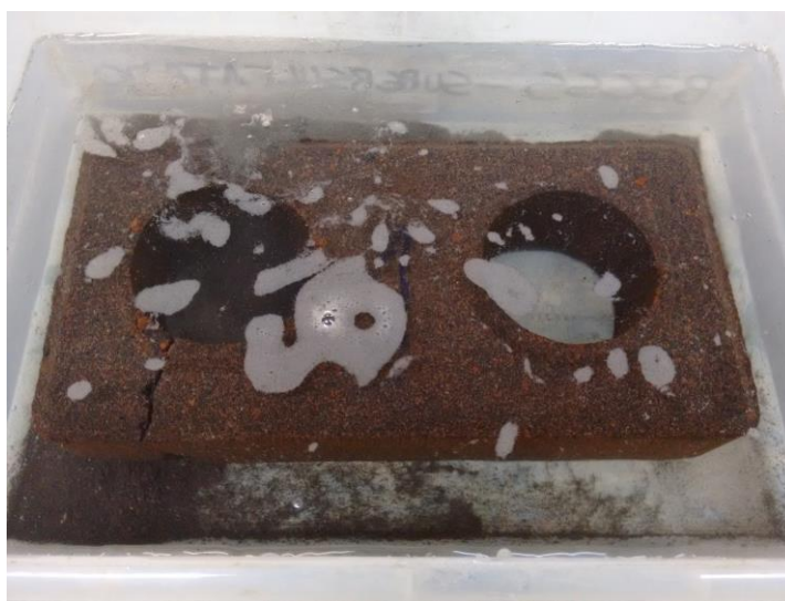
Figura 52 - Bloco logo após imersão em água no ensaio de absorção Fonte: Acervo Pessoal (2017).
