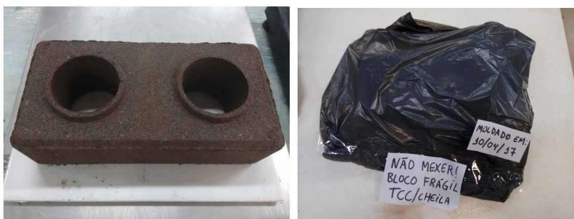
(a) (b) Figura 37 - Blocos de solo-cimento: (a) Logo após a moldagem; (b) Preparados para a cura Fonte: Acervo Pessoal (2017).
