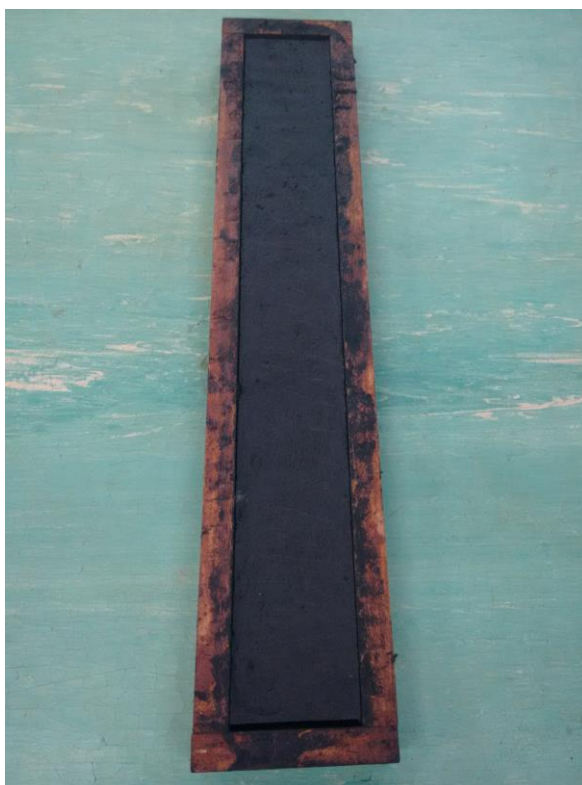
Figura 26 - Ensaio da caixa – Mistura 10/90 Fonte: Acervo Pessoal (2017).
