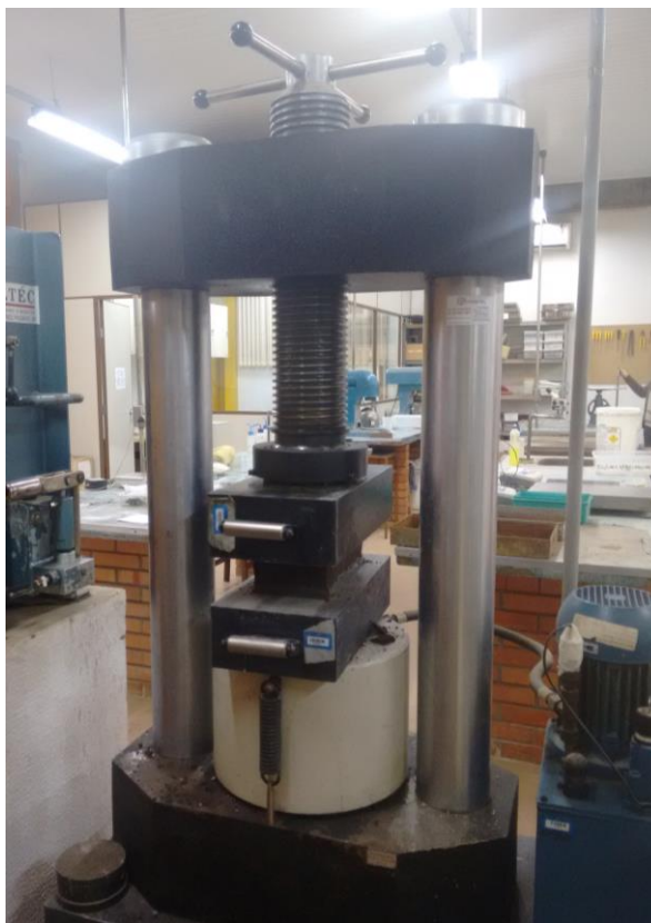
Figura 39 - Máquina utilizada para ensaio de resistência à compressão
