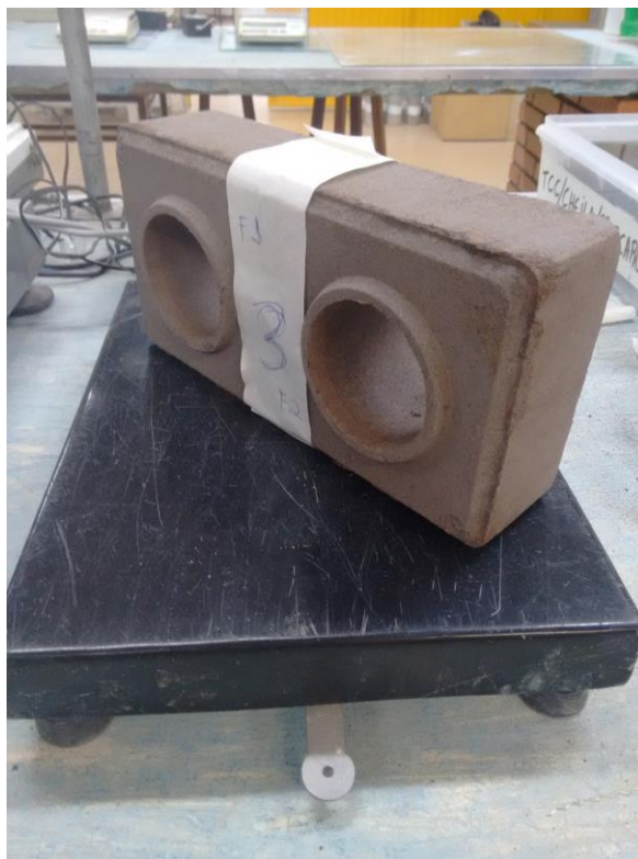
Figura 47 - Determinação de massa com uso de balança Fonte: Acervo Pessoal (2017).
