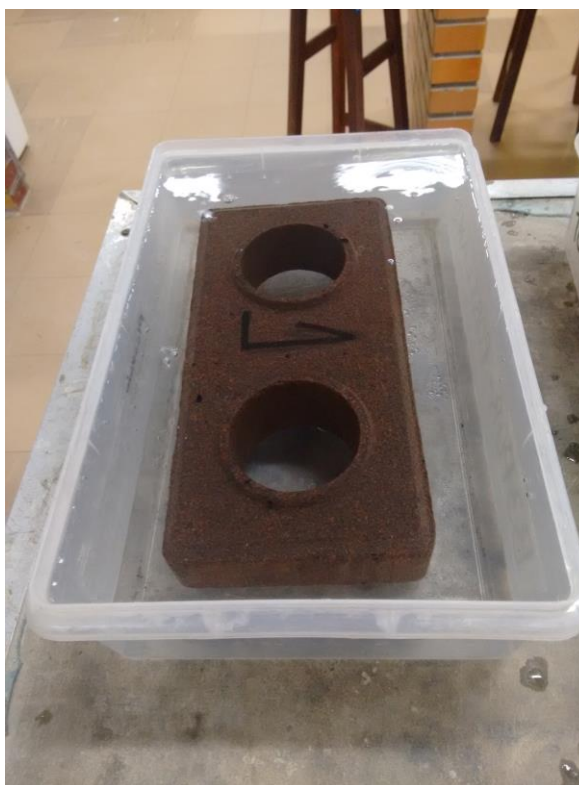
Figura 46 - Bloco submerso em ensaio de durabilidade Fonte: Acervo Pessoal (2017).
