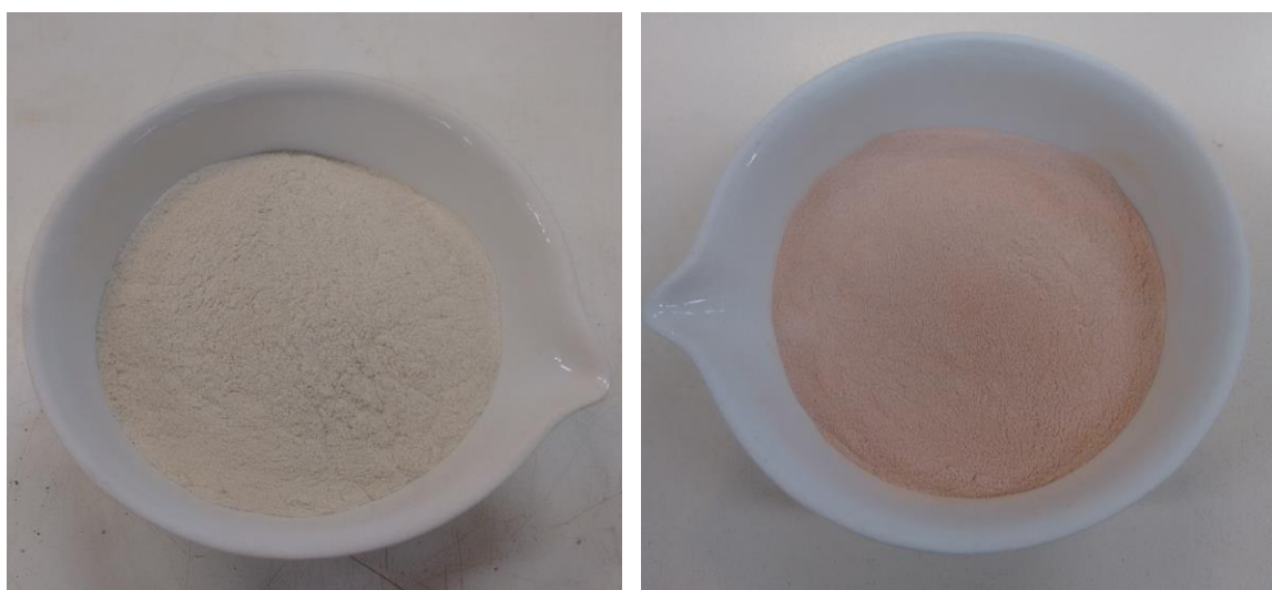
(a) (b) Figura 14 - Fosfogesso (a) in natura; (b) calcinado à 650°C Fonte: Acervo Pessoal (2017).
