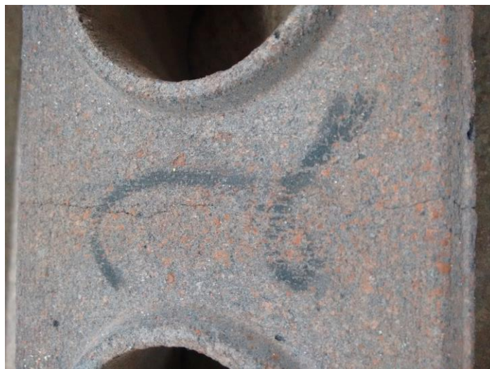
Figura 59 - Bloco B2 após ensaio de durabilidade
