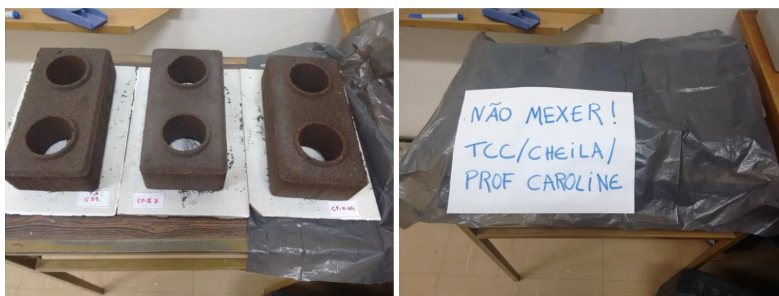
Figura 54 – Blocos de solo-cimento submetidos a cura aberta
