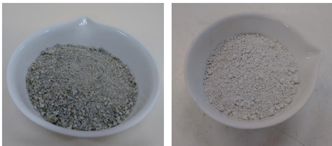
(a) (b) Figura 12 - Escória de alto-forno básica: (a) granulada; (b) moída Fonte: Acervo Pessoal (2017).
