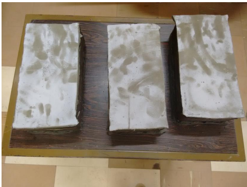
Figura 41 - Blocos capeados para ensaio de resistência à compressão Fonte: Acervo Pessoal (2017).
