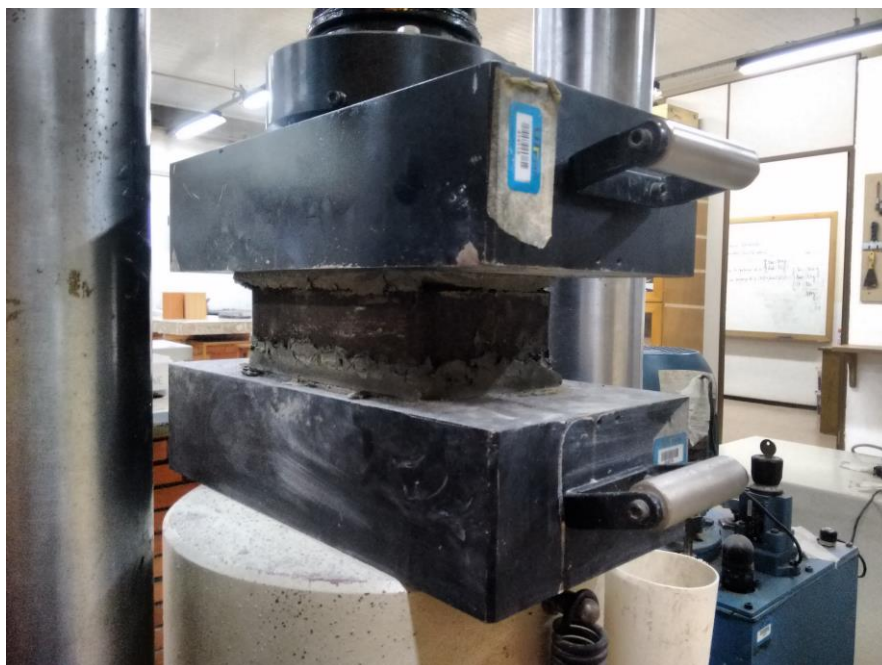
Figura 42 - Bloco em ensaio de resistência à compressão Fonte: Acervo Pessoal (2017).
