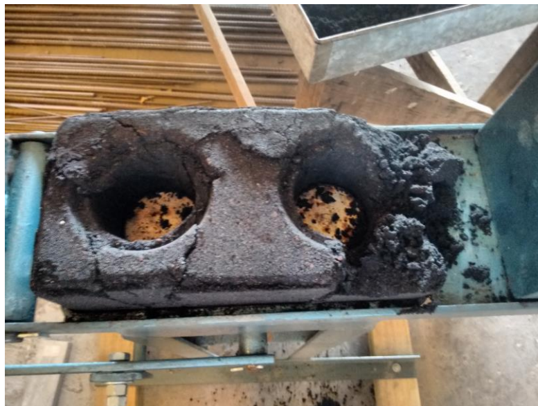
Figura 27 - Bloco fragmentado após tentativa de retirada da prensa Fonte: Acervo Pessoal (2017).
