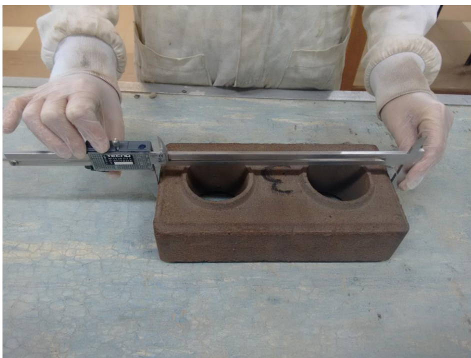
Figura 48 - Determinação de volume com uso de paquímetro digital Fonte: Acervo Pessoal (2017).
