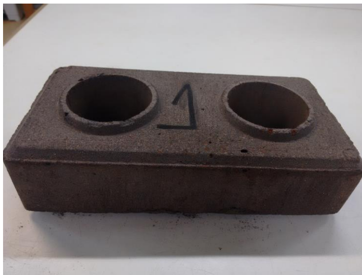
Figura 58 - Bloco B1 após ensaio de durabilidade
