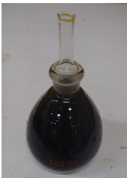
Figura 18 - Ensaio do picnômetro Fonte: Acervo Pessoal (2017).
