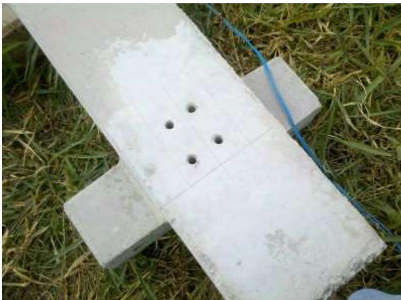
**Figura 37 - Furos onde serão posicionadas as barras de aço**
