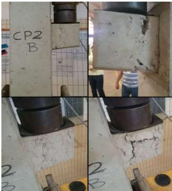
**Figura 49 – Ruptura CP<sub>norma2</sub>**
