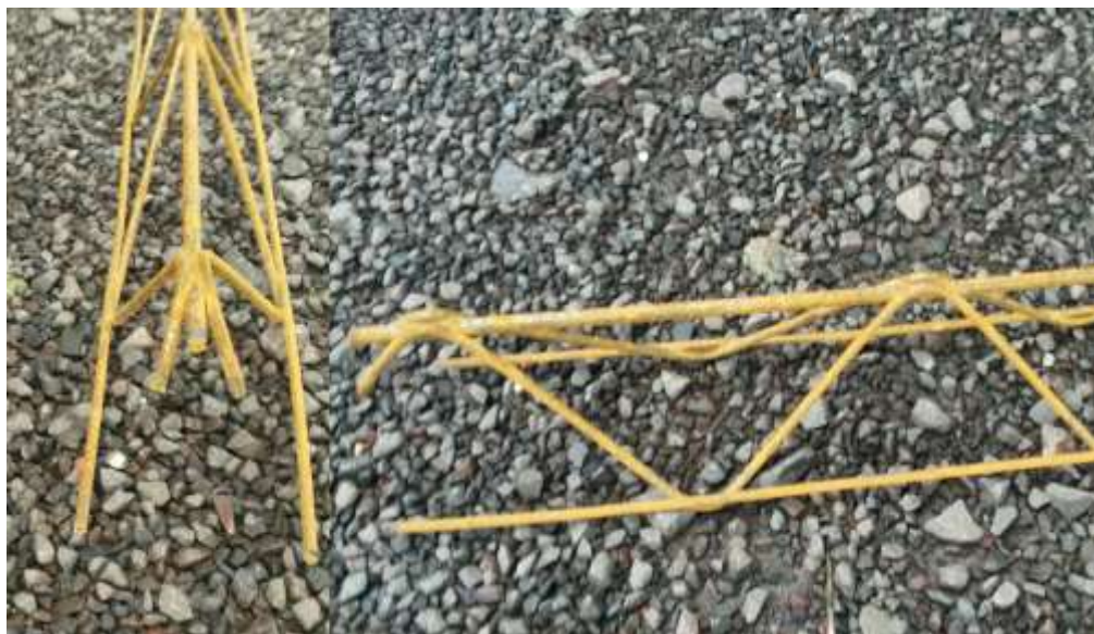
Figura 12: Treliça metálica de vigotas. Fonte: Foto adquirida pelos autores.
