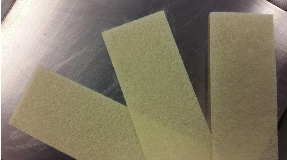
Figura 19 – Aramid Veil 50 g/m 2 Fonte: Aatoria própria (2015)
