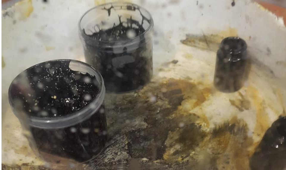
Figura 24 – Mistura dos nanocompósitos com a resina epóxi na máquina a vácuo Fonte: Autoria própria (2015)
