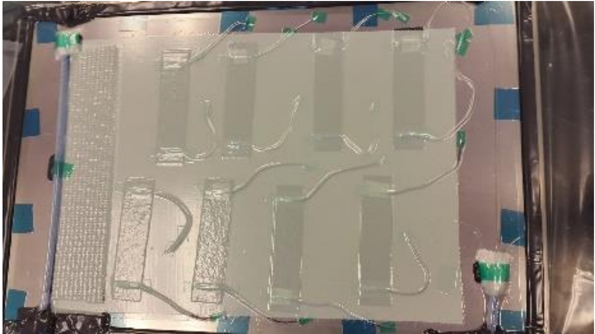
Figura 35 – Conjunto pronto para infusão Fonte: Autoria própria (2015)
