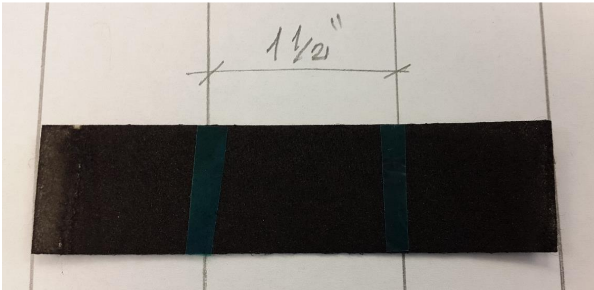
Figura 34 – Fita adesiva para alta temperatura colada na fibra com nanotubo de carbono Fonte: Autoria própria (2015)
