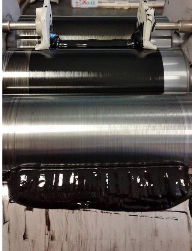
Figura 23 – Processamento do nanocompósitos misturados com a resina epóxi Fonte: Autoria própria (2015)
