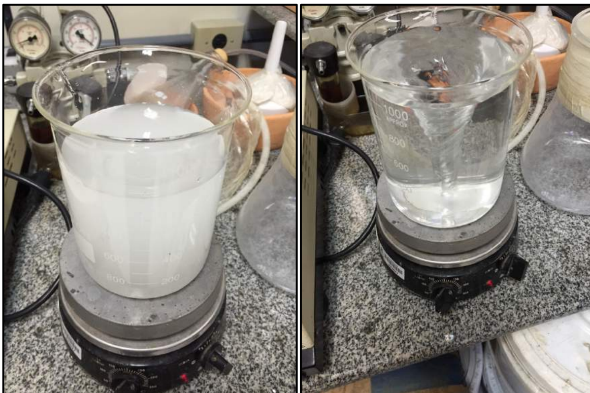
Figura 30 - Solução de sulfato de sódio preparada. Fonte: O Autor (2016).
