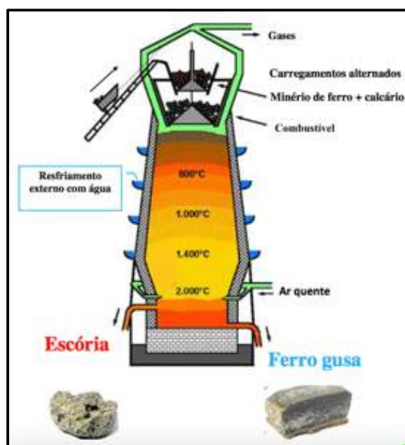
Figura 8 - Representação de alto forno para a produção de ferro gusa Fonte: Adaptado de Seilnacht (2015).
