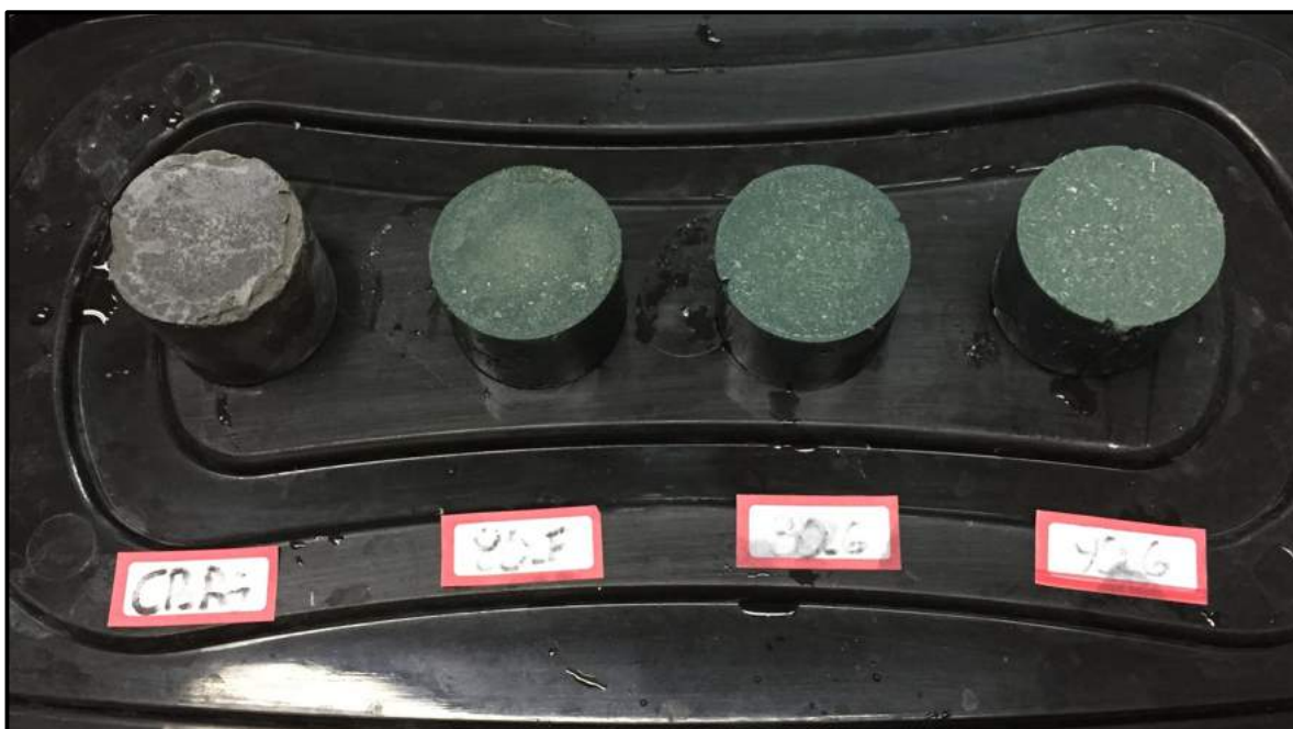
Figura 37 - Pastas de CSS e CP para análises químicas. Fonte: O Autor (2016).
