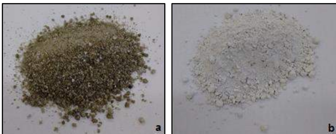
Figura 23 - Escória de alto forno (a) antes e (b) depois de moída. Fonte: Gracioli (2016).
