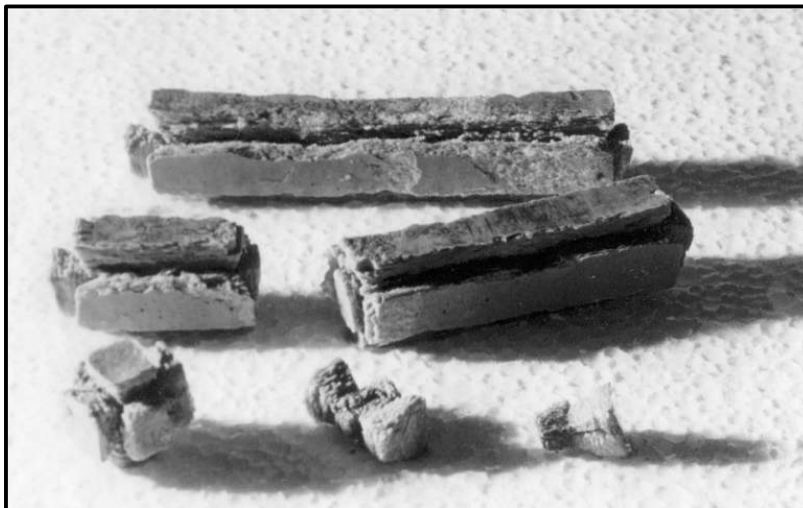
Figura 1 - Barras de CSS expostas a solução de sulfato de magnésio Fonte: Grounds et al. (2003).
