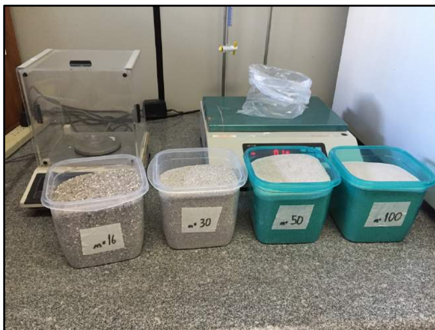
Figura 32 - Areia normal de ensaio utilizada. Fonte: O Autor (2016).
