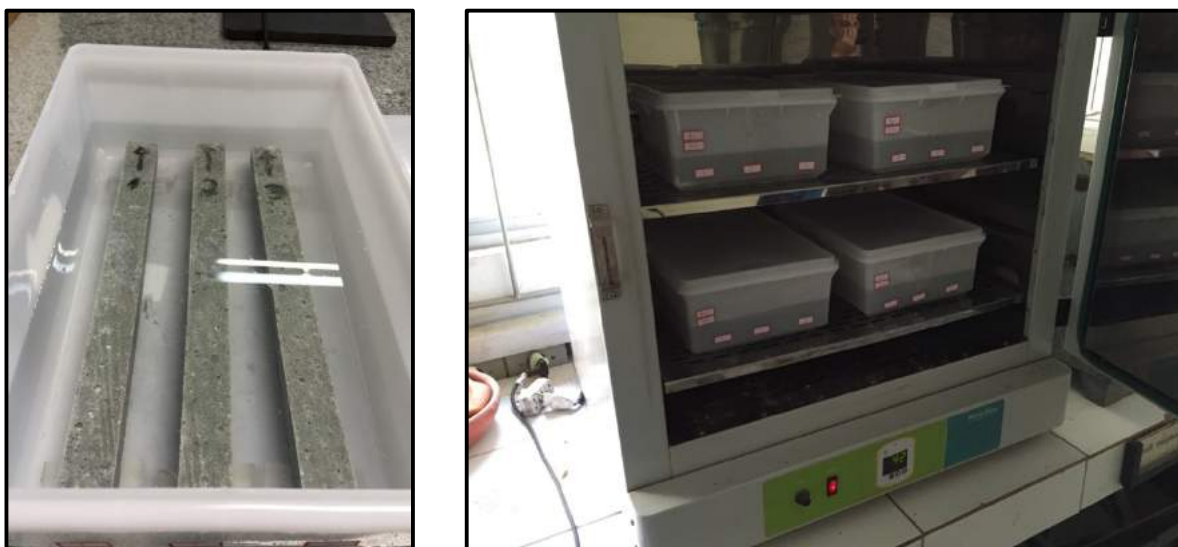
Figura 36 - Recipientes contendo as amostras acomodados em estufa a 40°C. Fonte: O Autor (2016).
