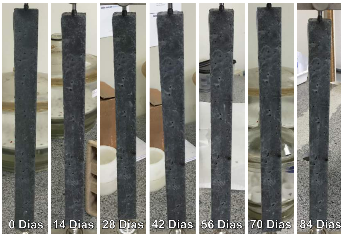
Figura 40 - CP's (CP_RS) expostos a sulfatos nas idades de medição. Fonte: O Autor (2016).
