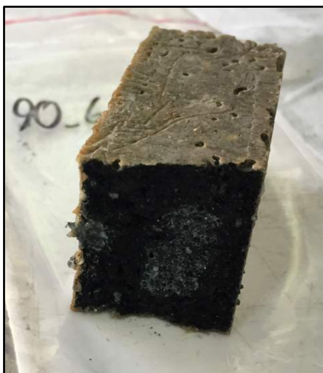
Figura 45 - Penetração de solução de sulfato em corpo de prova. Fonte: O Autor (2016)
