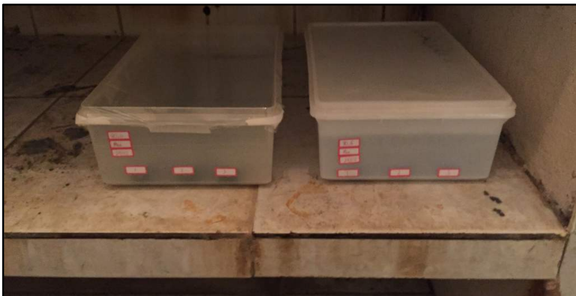
Figura 34 - Armazenamento das amostras em solução de água saturada com cal. Fonte: O Autor (2016).
