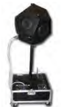
Figura 33 – Fonte omnidirecional de ruído Fonte: AcoemGroup (2014).
