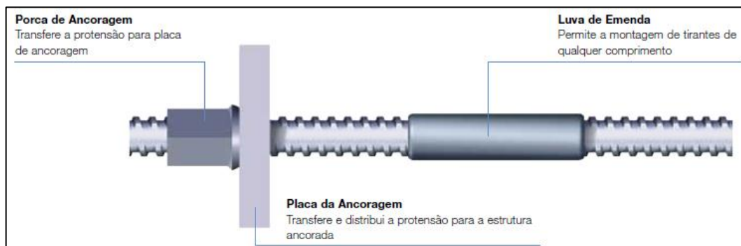
Figura 8 – Sistema de ancoragem com rosca e porca
