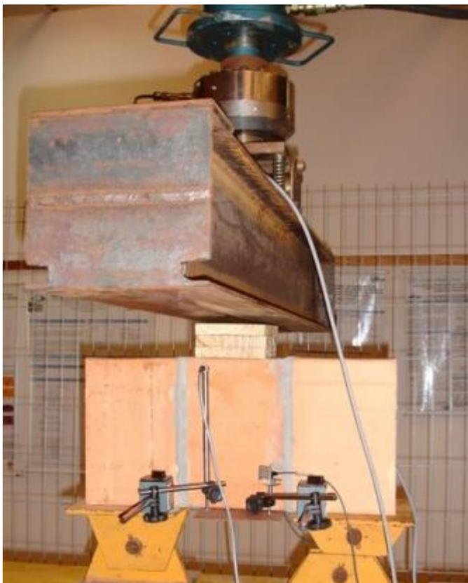
**Figura 13: Esquema de aplicação de carregamento**
