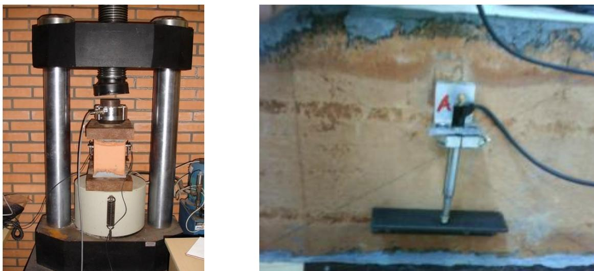
Figura 10 – Ensaio para determinação do Módulo de Elasticidade.
