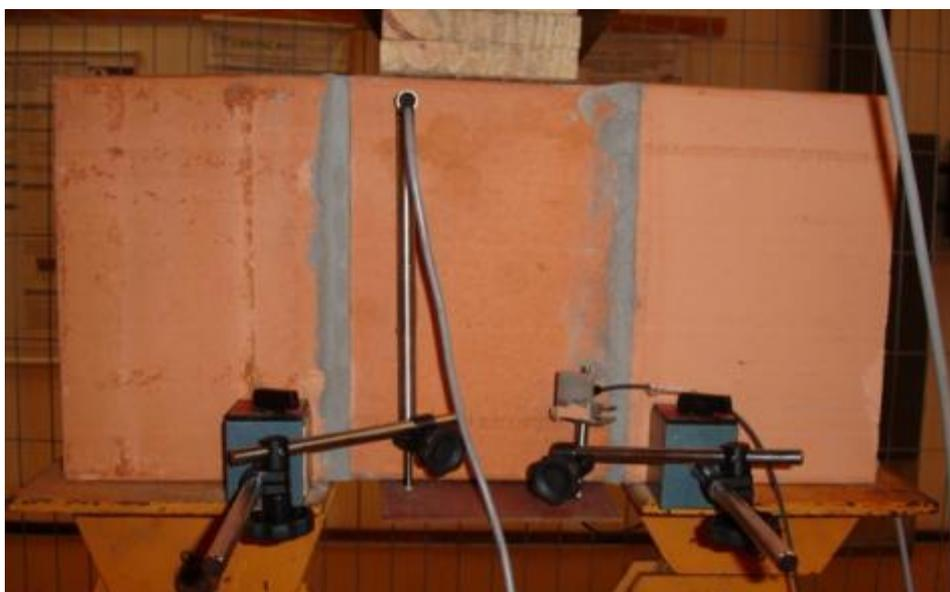
**Figura 12: Prisma utilizado no ensaio de cisalhamento**
