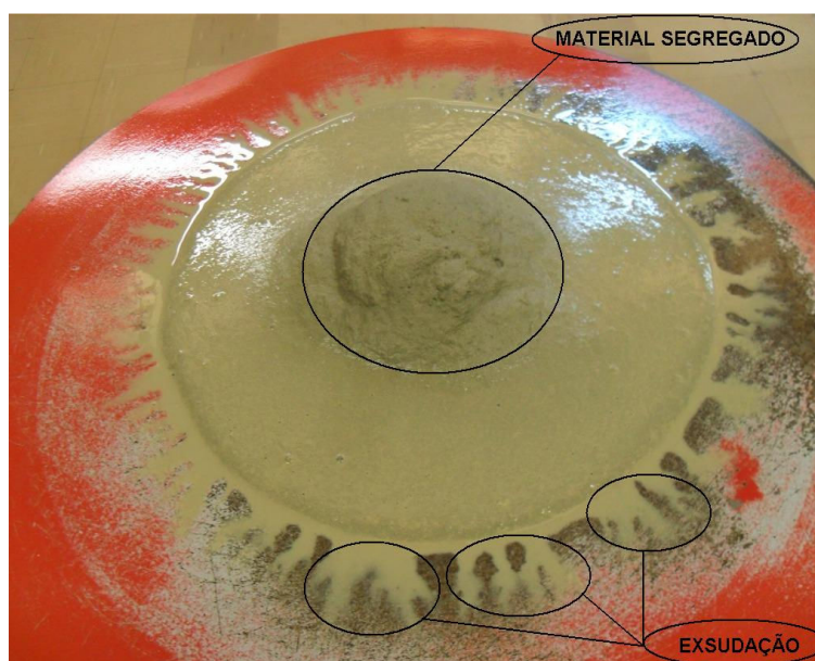
Figura 2: Exsudação e segregação em argamassa fluida
