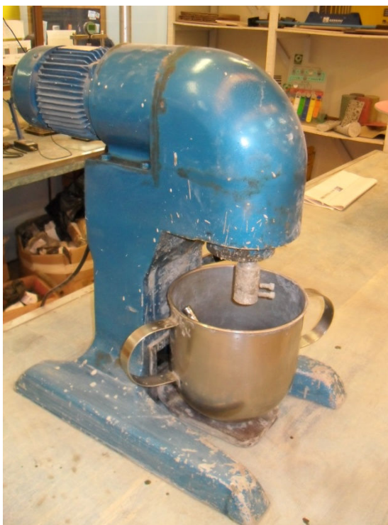
Figura 12: Argamassadeira mecânica utilizada para o preparo das misturas
