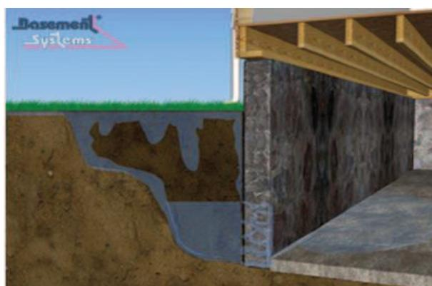
**Figura 7 – Entrada de água na fundação *Basement Wall*.**
