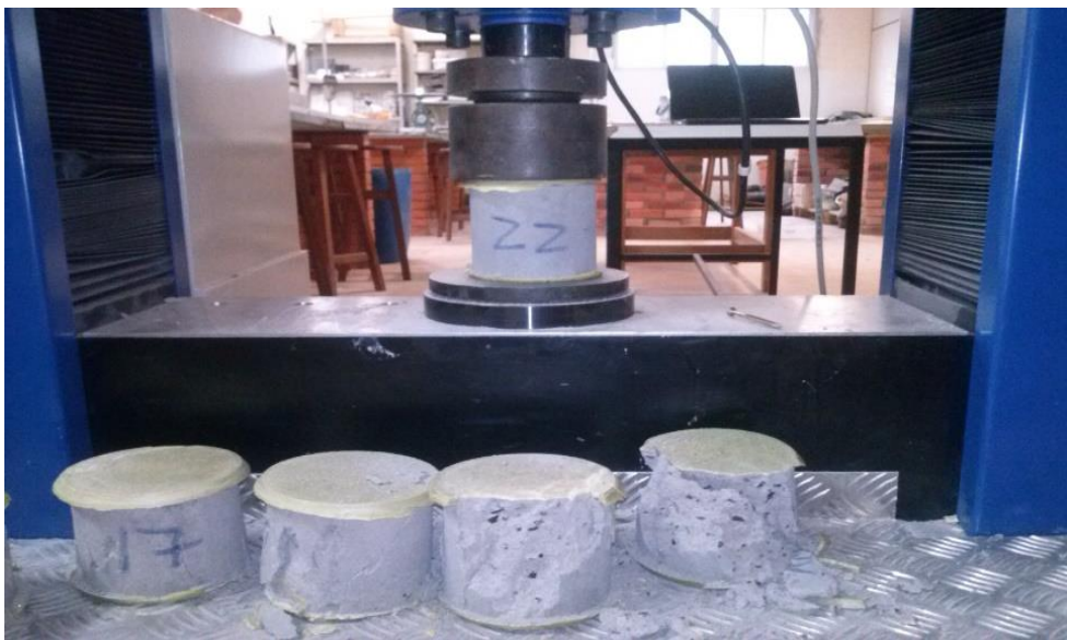
Figura 22 – Rompimento dos corpos de prova Fonte: Autoria própria (2014)
