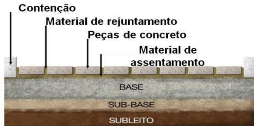
Figura 8 - Seção típica de pavimento intertravado Fonte: Associação Brasileira de Cimento Portland (ABCP)
