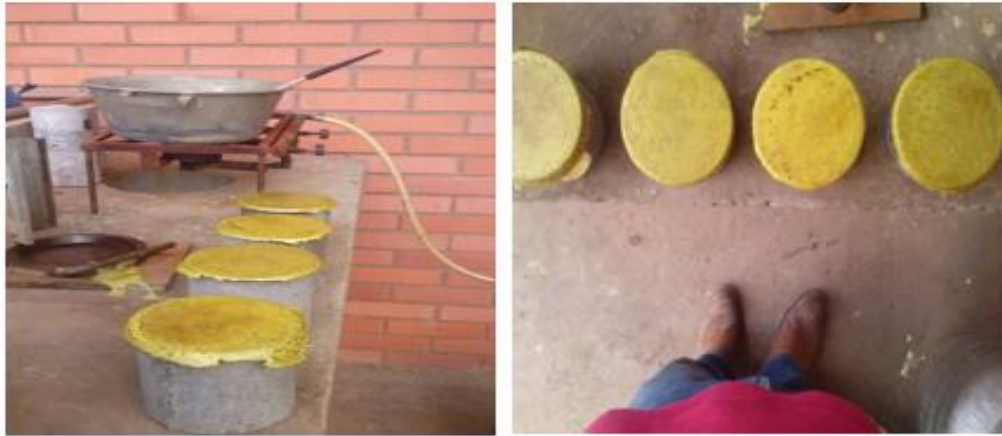
Figura 21 - Capeamento dos corpos de prova Fonte: Autoria própria (2014)
