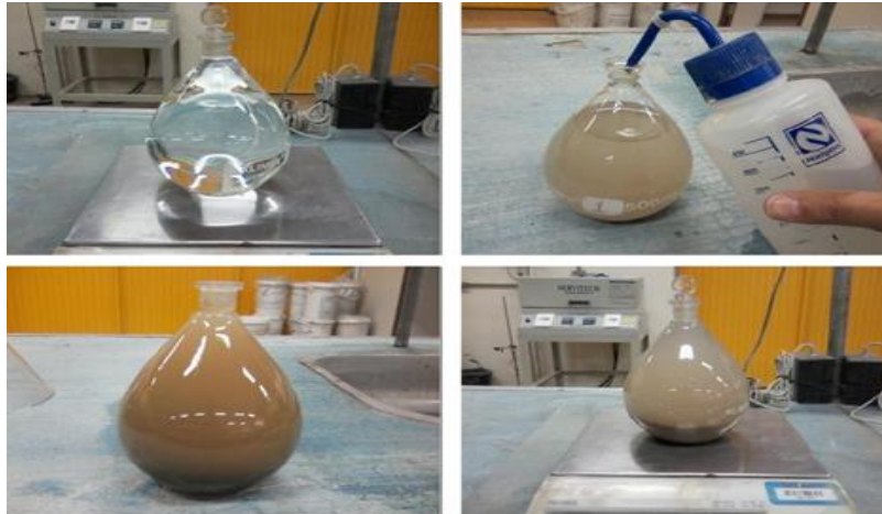
Figura 25 – Procedimento para determinação da massa específica Fonte: Autoria própria (2014)
