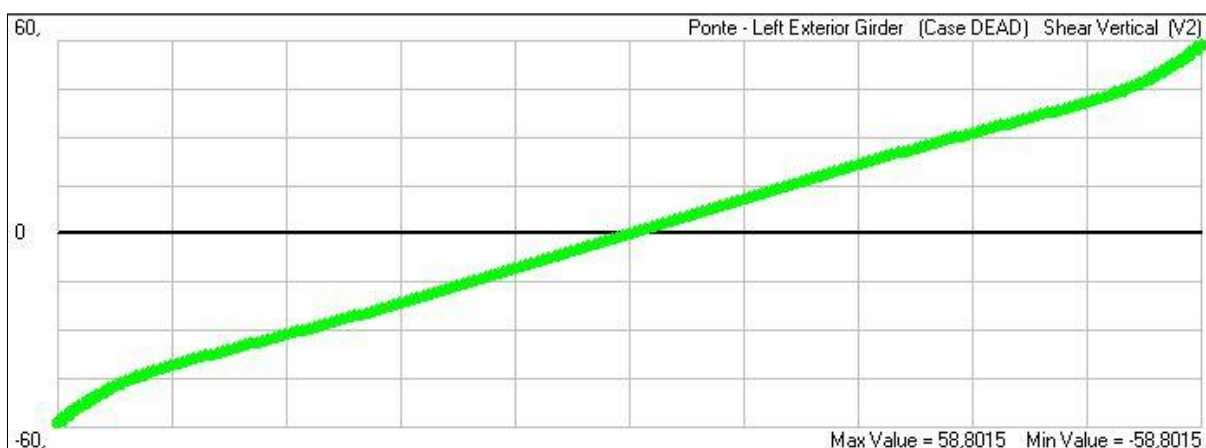
Figura 70 – Diagrama de Esforço Cortante resultante das cargas de peso próprio em kN (Método II)
