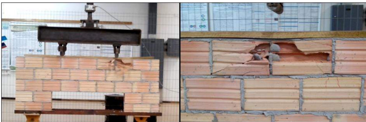
Figura 31 – Sequência de ruptura do protótipo com reforço de barras de aço 1 Fonte: Autora (2014).
