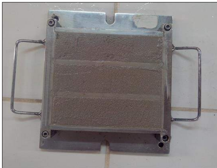
Figura 19 – Corpos-de-prova prismáticos de argamassa. Fonte: Autora (2014).
