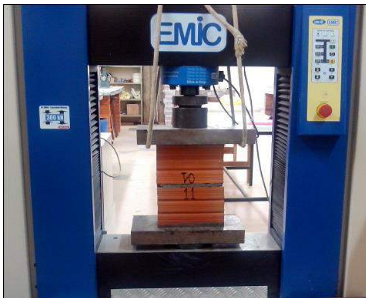
Figura 22 – Ensaio de compressão da argamassa. Fonte: Autora (2014).
