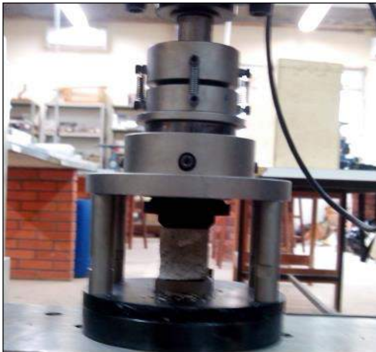
Figura 20 – Ensaio de compressão da argamassa. Fonte: Autora (2014).
