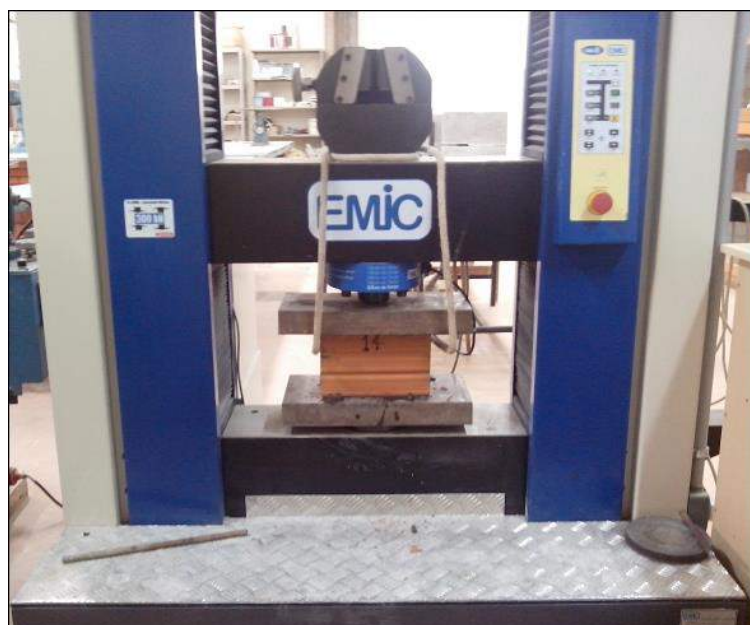
Figura 18 – Ensaio de compressão do bloco cerâmico na EMIC Fonte: Autora (2014)
