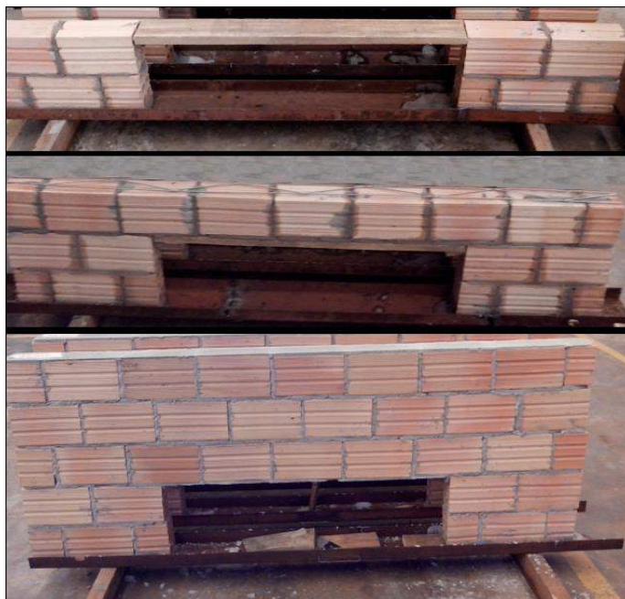
Figura 25 – Sequencia de construção do protótipo. Fonte: Autora (2014).
