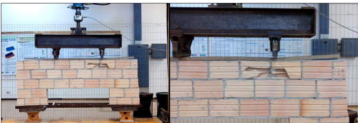
Figura 35 – Sequência de ruptura do protótipo com reforço de treliça Murfor 2 Fonte: Autora (2014).
