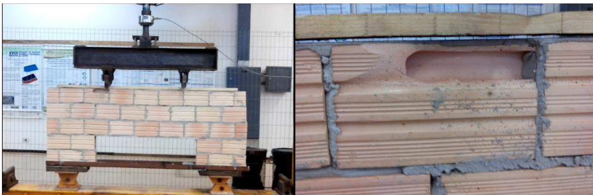
Figura 34 – Sequência de ruptura do protótipo com reforço de treliça Murfor 1 Fonte: Autora (2014).
