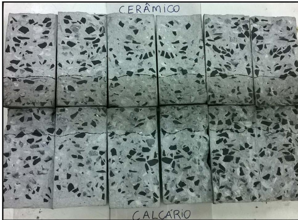
**Figura 33: CP's do ensaio de absorção rompido diametralmente.**
