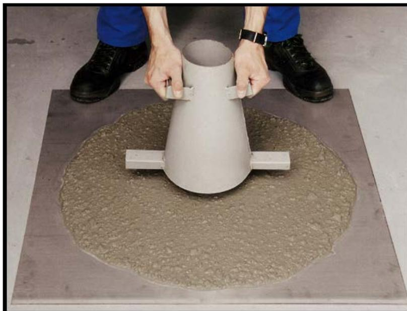
**Figura 9: Ensaio de espalhamento *slump flow*.**
