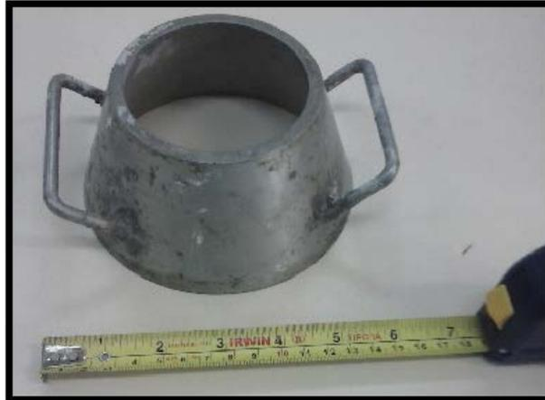
**Figura 7: Tronco de Cone para ensaios de *mini slump*.**
